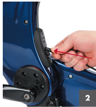
2 Po otwarciu gumowej pokrywki portu ładowania włóż do gniazda przewód ładowania.
