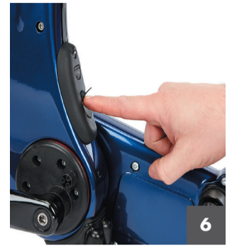
6 Po całkowitym naładowaniu akumulatora odłącz przewód ładowania i załóż gumową pokrywę portu ładowania
