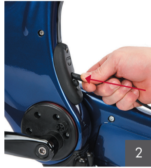
2 Удерживая резиновую заглушку в открытом положении, вставьте соединительный штекер зарядного устройства в порт.
