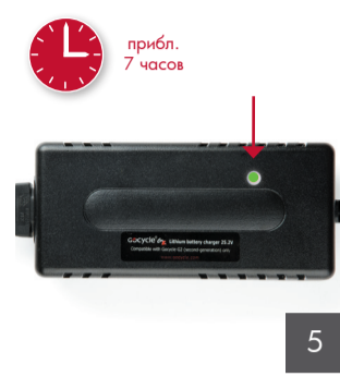
5 Если цвет индикатора на зарядном устройстве изменился на зеленый и на приборной панели мигают все десять светодиодов, значит зарядка завершена (см. шаг 2: С)
