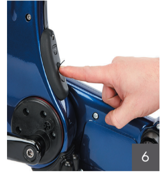
6 После того как аккумуляторная батарея полностью зарядится, отсоедините соединительный штекер зарядного устройства и закройте резиновую заглушку.
