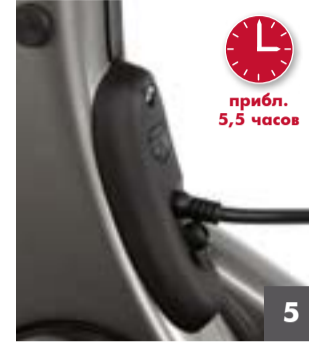
5 Если цвет индикатора на зарядном устройстве изменился на зеленый и на приборной панели мигают все десять светодиодов, значит зарядка завершена (см. шаг 2: C)
