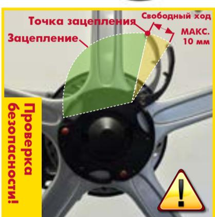
Откройте и закройте КАЖДЫЙ эксцентрик, чтобы убедиться в том, что он отрегулирован и работает, как показано на рисунке. При необходимости регулировки см. Руководство по эксплуатации электровелосипеда Gocycle. ЗАПРЕЩАЕТСЯ ездить на электровелосипеде, если эксцентрики болтаются или усилие, которое необходимо приложить для закрывания или открывания, отличается в зависимости от эксцентрика.
