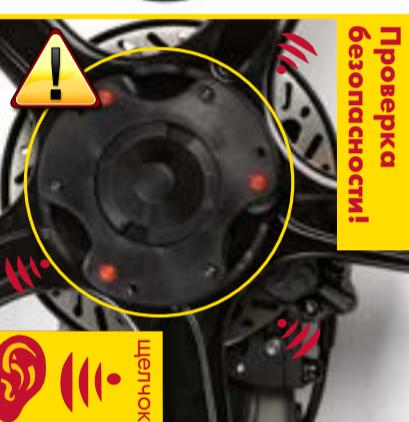
Убедитесь в том, что все эксцентрики на переднем и заднем быстросъемных колесах PitstopWheels полностью закрыты. При закрывании каждого эксцентрика должен раздаться характерный щелчок
