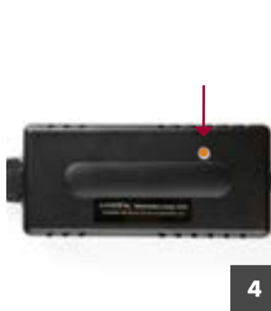
4 Świecąca na pomarańczowo kontrolka ładowarki oznacza, że rozpoczęto ładowanie
