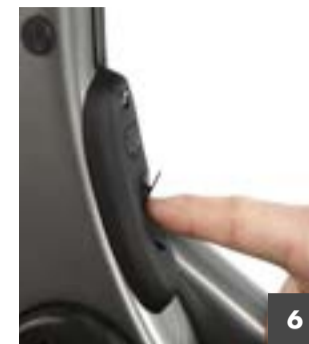
6 Po całkowitym naładowaniu akumulatora odłącz przewód ładowania i załóż gumową pokrywę portu ładowania
