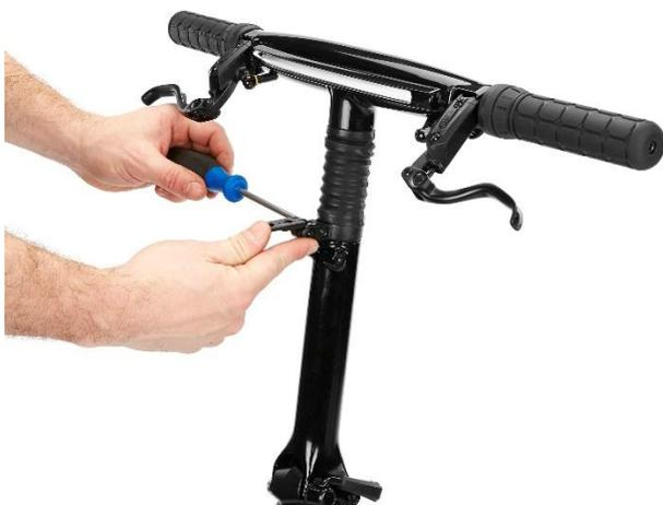
Placez l'étrier autour de la partie haute de la potence et serrez avec un tournevis pour le maintenir en place comme indiqué.
