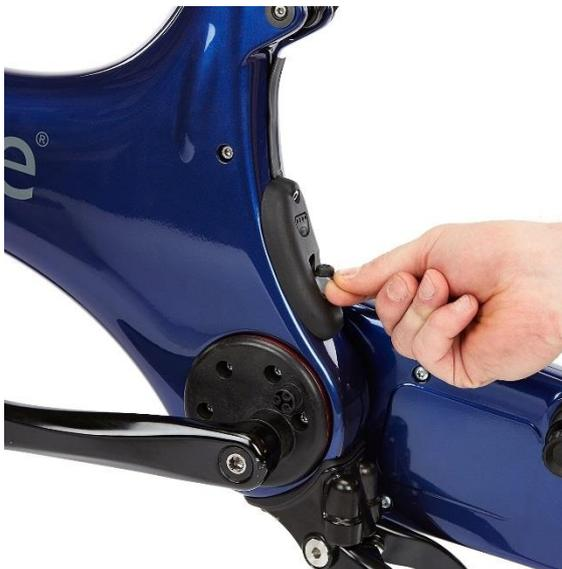
Ouvrez le bouchon en caoutchouc du port de charge, comme indiqué
