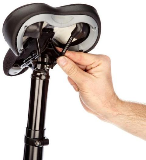
1.3. Faites pression sur le côté droit du porte-outil Snap-Rail (B) jusqu'à ce que ce côté soit positionné correctement sur la traverse côté droit de la selle.
