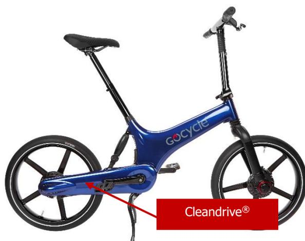
Il n'y a pas besoin d'inspecter, nettoyer ni graisser les composants internes du système Cleandrive®.
