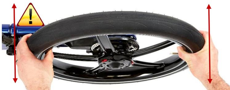
Pour vérifier si un réglage est nécessaire, tout en exerçant une pression légère, faites bouger la roue à la jante d'un côté à l'autre.
