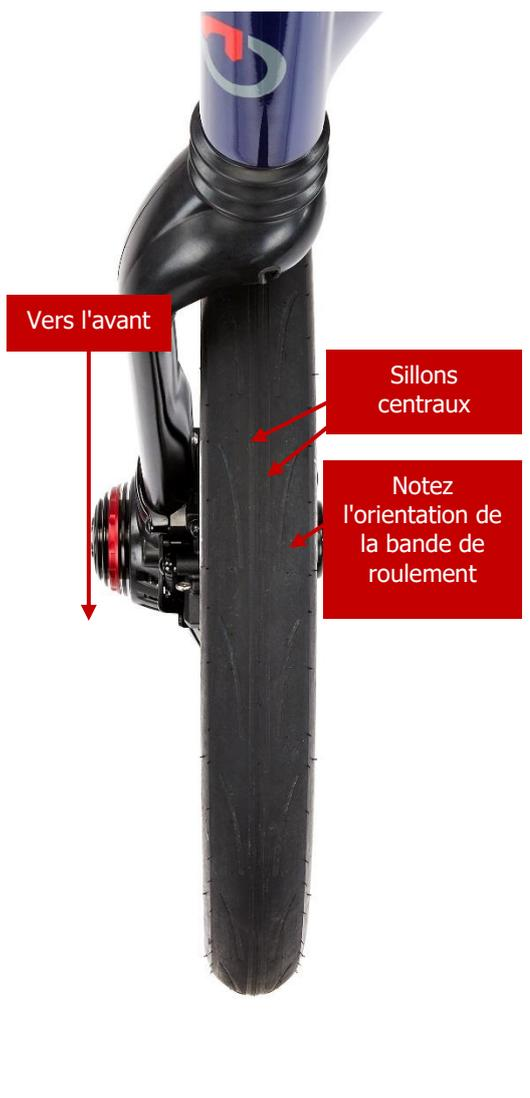
Montage du pneu et orientation de la bande de roulement
