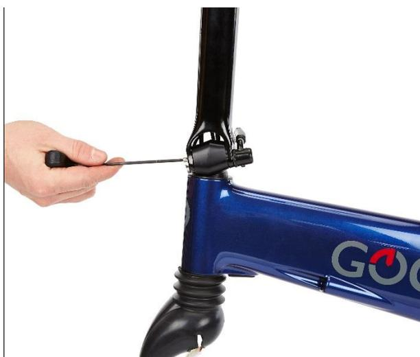
Desserrez le boulon de serrage de l'écrou à l'aide d'une clé Allen de 2,5 mm.
