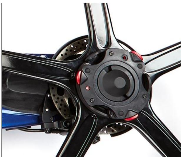
8. Effectuez une contre-vérification : avec le Hexlock™ en position non verrouillée, on doit maintenant relever une résistance égale sur les trois leviers à came, nécessitant une force de 3 à 5 kg pour ouvrir un levier à came individuel.
