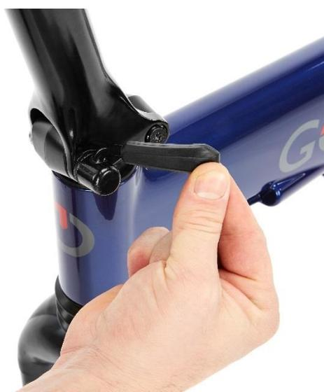
Resserrez le levier. Il doit être plus dur à serrer quand il approche l'angle de 90°.
