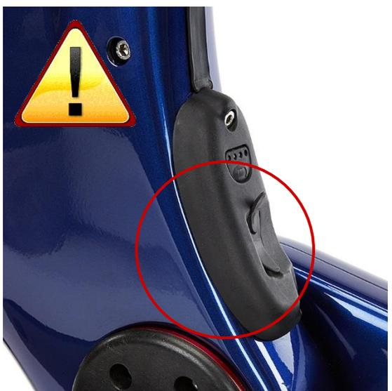
Vérifiez que le bouchon en caoutchouc du port de charge est en place avant de rouler.
