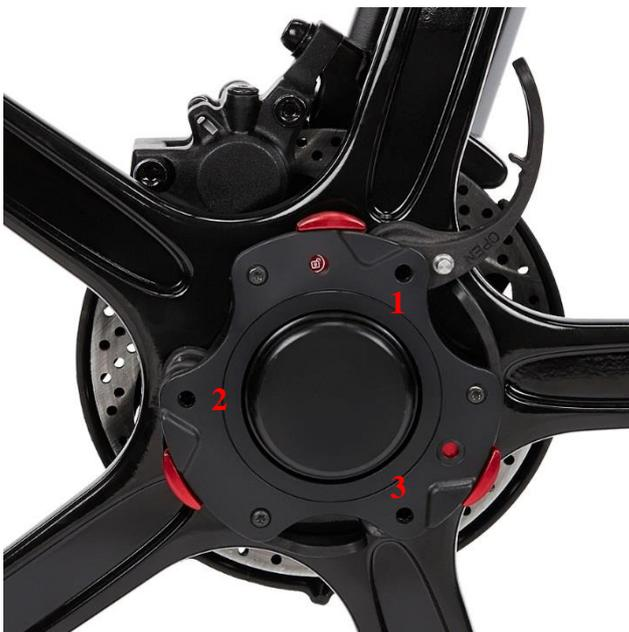
7. Répétez l'opération pour les deux autres leviers à came, puis procédez à un nouveau contrôle intégral sur chaque levier à came, afin d'assurer qu'une fois réglée et stabilisée, la résistance à la fermeture des leviers à came est la même pour les trois leviers.
