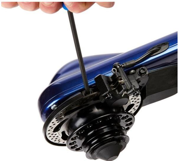
Remplacez les deux boulons de fixation de l'étrier. Serrez à un couple de 6-8 Nm.
