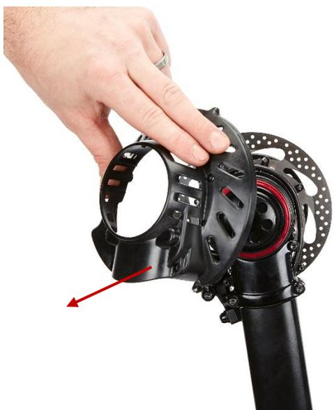
Repérez et retirez les six boulons de fixation du capot du moteur
