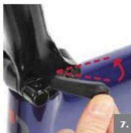
7. Le raccord rapide doit commencer à devenir plus dur à fermer lorsqu'on s'approche de 90 degrés.
