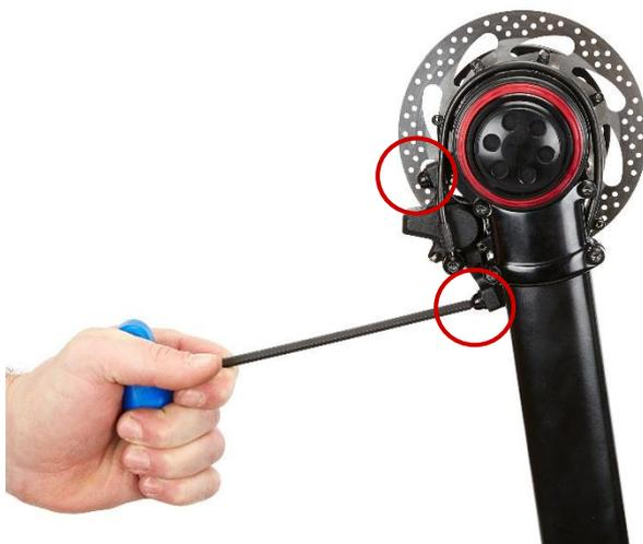
Repérez et retirez les deux boulons de fixation de l'étrier.
