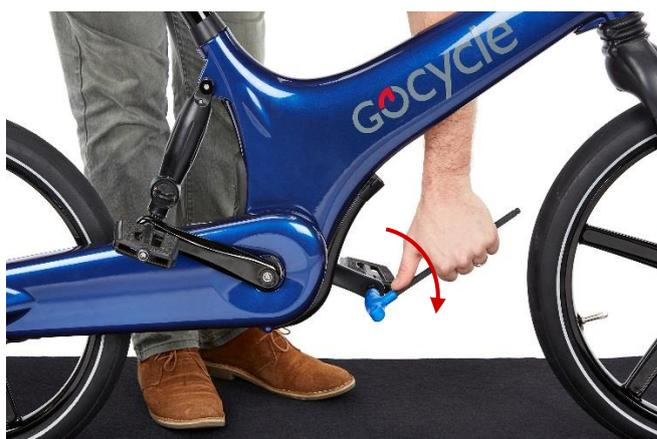
Avec une clé Allen de 8 mm, montez la pédale gauche comme sur la photo, en serrant jusqu'à 35-40 Nm dans la direction indiquée.
