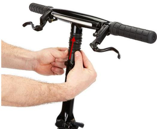
Levez le couvre-potence en caoutchouc pour exposer la partie haute de la potence.
