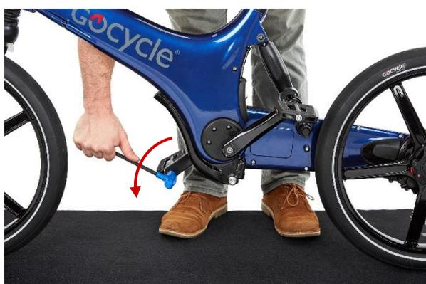
Avec une clé Allen de 8 mm, montez la pédale droite comme sur la photo, en serrant jusqu'à 35-40 Nm dans la direction indiquée.
