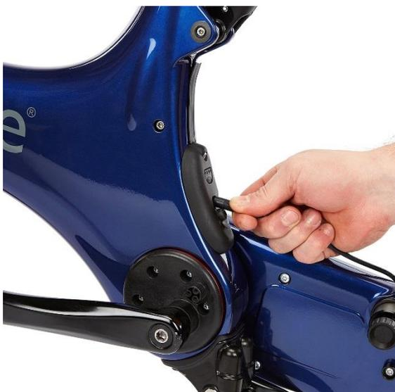
Tout en maintenant le bouchon en caoutchouc du port de charge ouvert, insérez le câble de charge, comme indiqué
