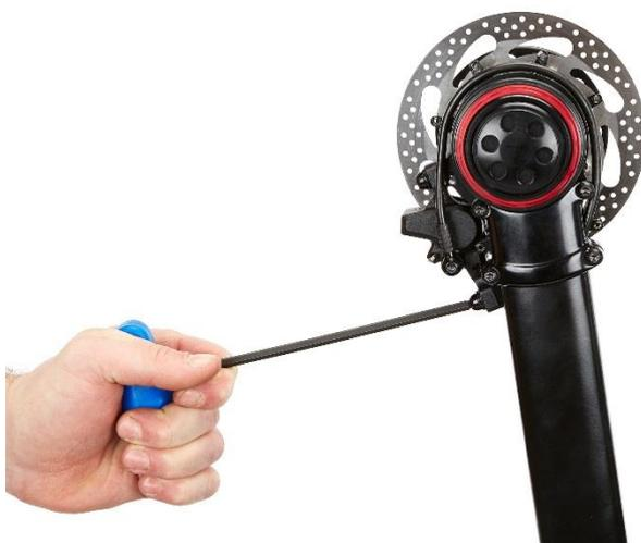
Remplacez l'étrier du frein avant. Serrez les boulons de fixation de l'étrier à un couple de 6-8 Nm.
