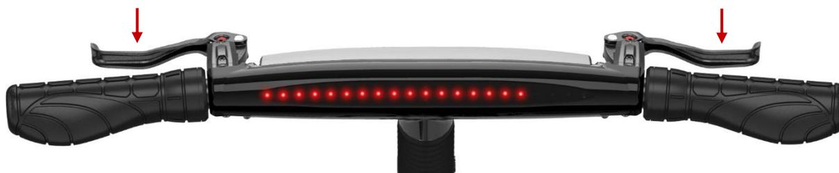
Le Gocycle est équipé, à l'avant et à l'arrière, de freins à disque hydrauliques actionnés par deux leviers situés sur le guidon (voir photo). Avant de prendre la route, familiarisez-vous avec les freins afin de bien distinguer le frein arrière et le frein avant. Une bonne utilisation des freins permet de ralentir et de contrôler en toute sécurité l'arrêt du Gocycle.
