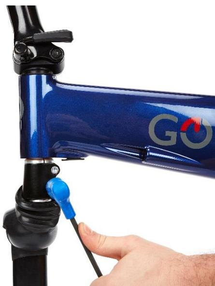
En veillant à ce que la fourche avant et le guidon soient alignés, serrez les deux boulons de tête de fourche à 10-12 Nm. NOTE : Il faudra revérifier deux fois pour assurer que le couple est le même sur les deux boulons.
