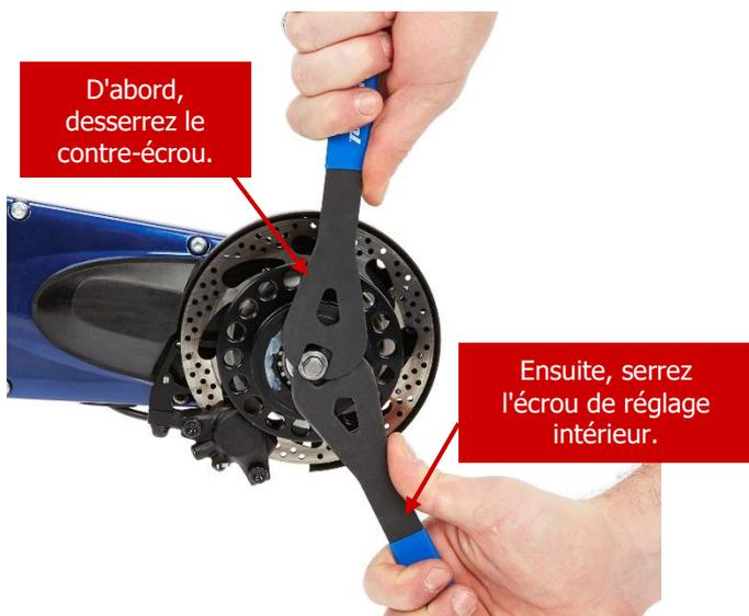
Avec deux clés de 14 mm, réglez les bagues de roulement d'engrenage du moyeu arrière.
