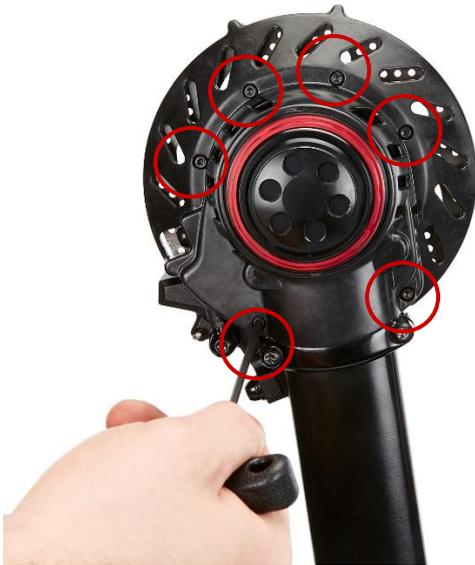
Remplacez les six vis de fixation du capot du moteur. Serrez à un couple de 3–4 Nm.
