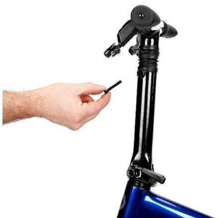
Réinsérez le boulon de la potence et resserrez à un couple de 6-8 Nm.
