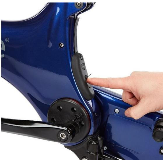
Retirez le câble de charge et remettez le bouchon en caoutchouc dans le port de charge
