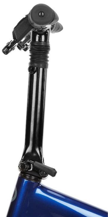
Vérifiez que le trou de boulon ainsi que celui de la position haute ou basse de la potence sont parfaitement alignés.
