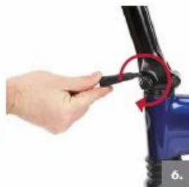
6. Insérez le raccord rapide dans la potence du guidon, et tournez en sens horaire pour serrer.
