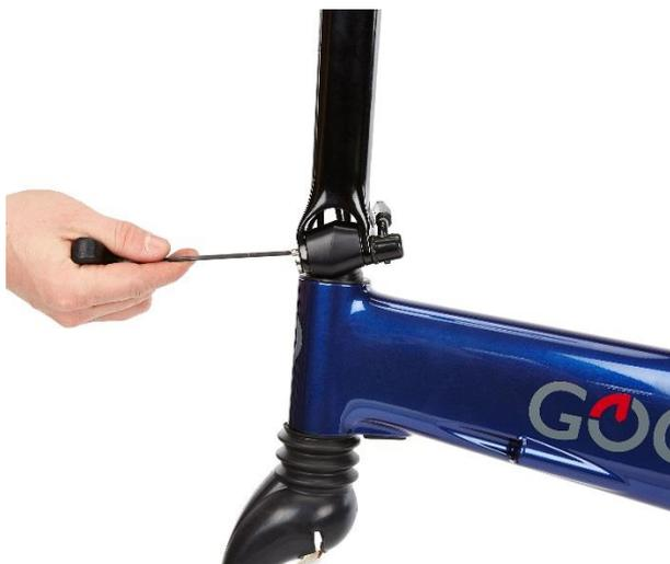
Après avoir effectué le réglage, et vérifié que la résistance à la fermeture agit sur les 60 derniers degrés du mouvement dans le levier de serrage rapide, remontez le boulon de fixation à l'aide d'une clé Allen de 2,5 mm.
