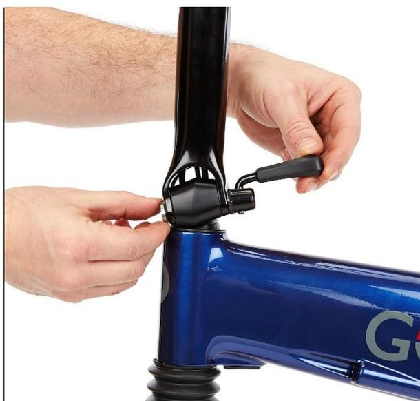
Ouvrez le levier de serrage rapide d'un quart de tour (90 degrés), puis tournez lentement l'écrou de serrage jusqu'à ce qu'il s'arrête contre la potence basse du guidon. Tournez de sorte qu'un des trous de l'écrou de serrage s'aligne avec le trou dans la potence basse, permettant ainsi le remontage du boulon de fixation.
