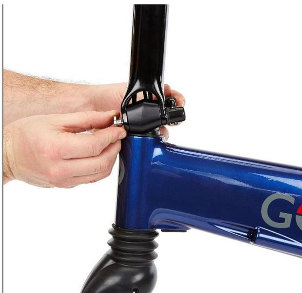
Installez le levier de serrage rapide en le maintenant dans la position fermée, et en s'assurant qu'il se trouve dans la zone appropriée, de la façon illustrée dans la photo ci-dessous.
