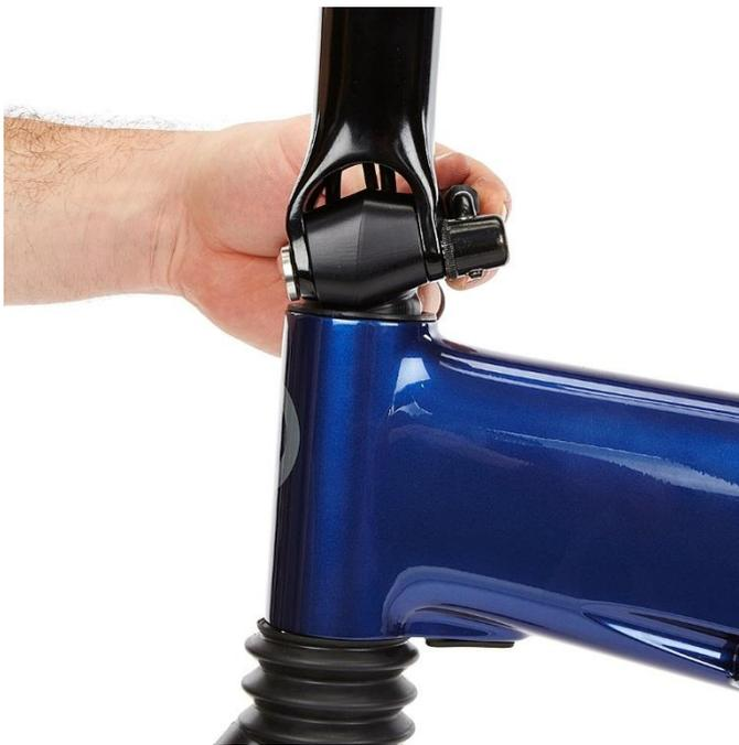
Le levier de serrage rapide doit présenter un **jeu** d'environ 120 degrés avant de commencer à s'engager. La résistance à la fermeture doit agir sur les 60 degrés restants du mouvement, jusqu'à ce qu'il se ferme dans son emplacement approprié.
