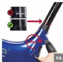
10. Vérifiez que la tige de selle a été enfoncée jusqu'au repère d'insertion minimum, puis serrez le boulon de fixation à 5 Nm à l'aide d'une clé Allen de 4 mm.
