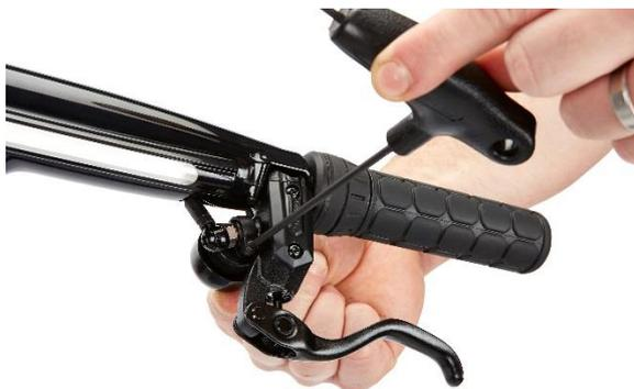
Serrez le support de montage avec un outil Torx T10 à 2-3 Nm.
