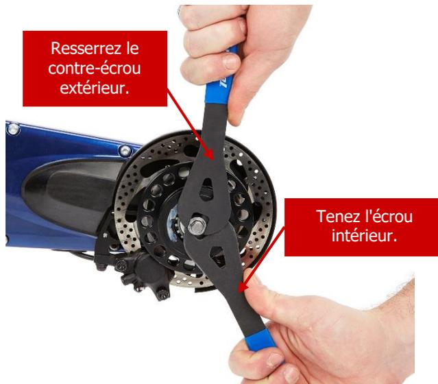
Entre les réglages, vérifiez que le moyeu arrière tourne en direction roue libre. Les écrous des bagues de roulement doivent être serrés jusqu'à ce que la roue n'ait pas plus d'un mm de jeu à la jante, et que la roue puisse tourner librement. C'est une question de compromis et de ressenti. En cas de doute, demandez les conseils de Gocycle Tech Support.
