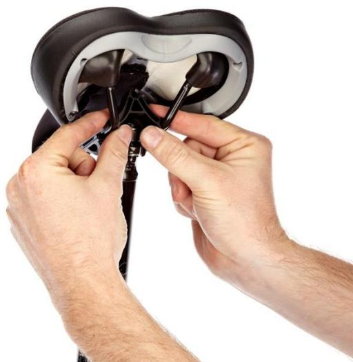
1.5. Vérifiez que les deux côtés du porte-outil Snap-Rail (B) sont positionnés correctement sur les traverses de la selle.
