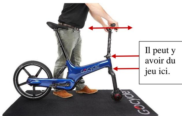
Vérifiez si la direction est bien serrée. Il ne doit y avoir aucun jeu dans l'ensemble du guidon.
