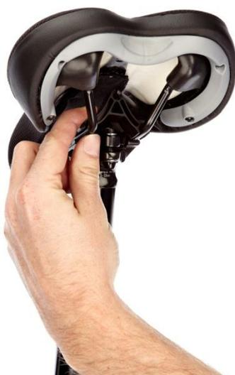
1.4. Faites pression sur le côté gauche du porte-outil Snap-Rail (B) jusqu'à ce que ce côté se soit positionné correctement sur la traverse côté gauche de la selle.
