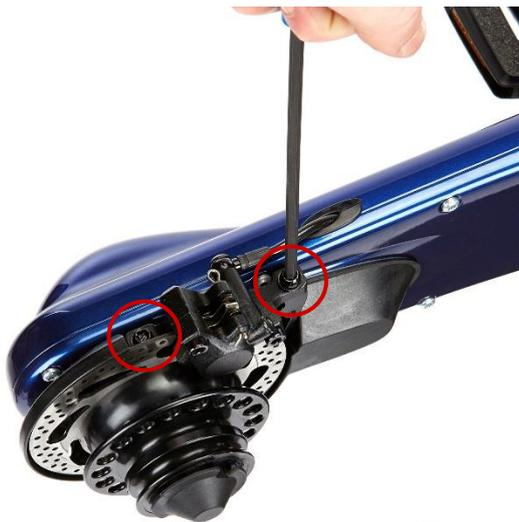
Repérez les deux boulons de fixation de l'étrier indiqués sur la photo.
