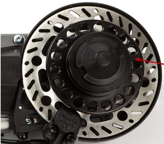
Retirez régulièrement la roue arrière pour regarder si le moyeu présente des signes d'usure
