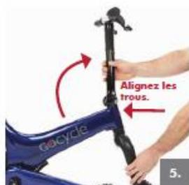
5. Continuez de déplier le guidon comme sur la photo, et alignez le trou avant dans le mécanisme de pliage.
