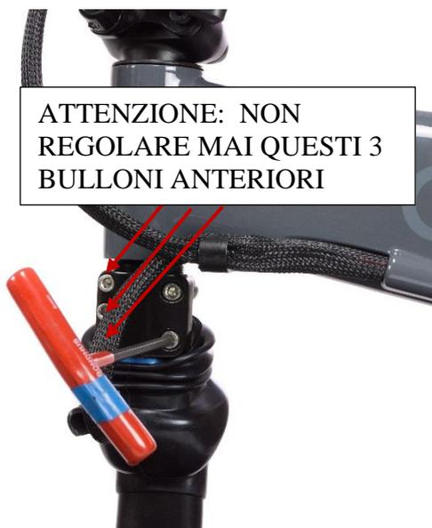
Accertarsi che la forcella anteriore e i manubri siano allineati, quindi serrare i due bulloni della corona della forcella a una coppia di 10-12 Nm. NOTA: Sarà necessario ricontrollare entrambi i bulloni due volte per verificare che la coppia sia uniforme. Reinstallare la protezione in gomma.
