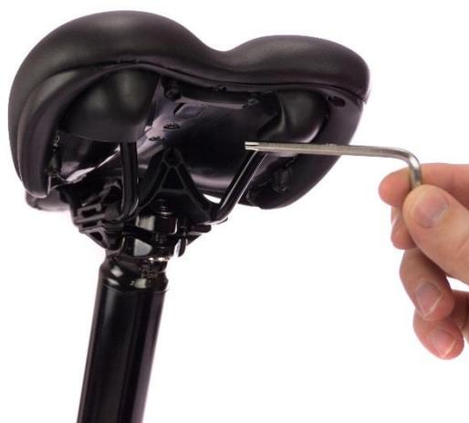
Inserire la chiave a brugola da 4 mm in dotazione con la Gocycle.
