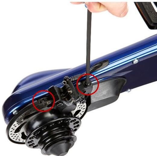
Identificare i due bulloni di fissaggio della pinza freno posteriore (figura).
