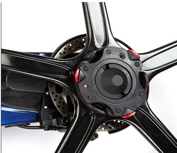
Controllo incrociato: con il sistema Pitstoplock™ in posizione di sblocco, la resistenza dovrebbe risultare uguale per tutte le leve a camme, con forza di resistenza di 3-5 kg per l'apertura di ciascuna leva.
