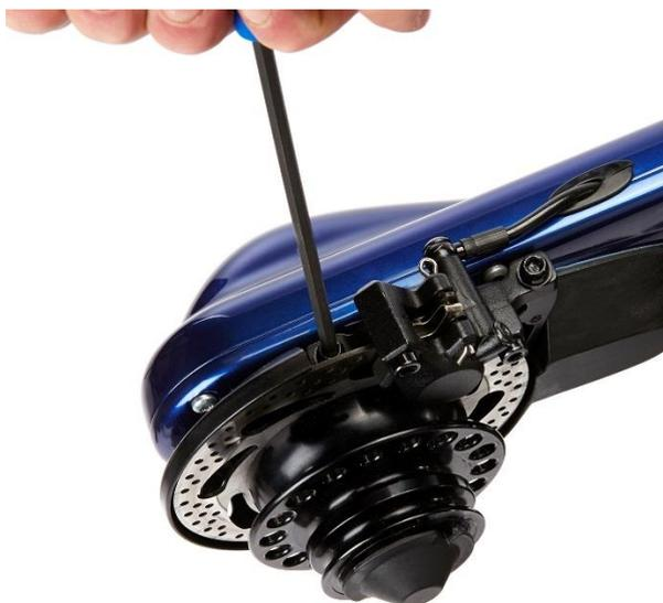
Reinstallare entrambi i bulloni di fissaggio della pinza freno. Serrare a una coppia di 6-8 Nm.
