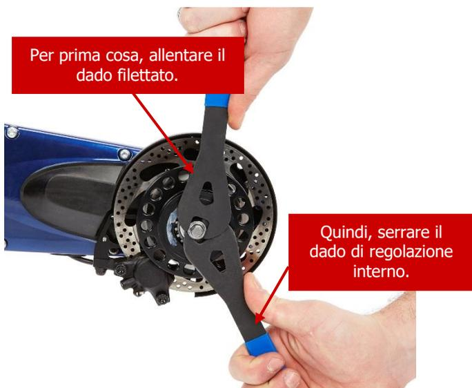
Utilizzando (2) chiavi inglesi da 14 mm, regolare il cono del cuscinetto del cambio epicicloidale.
