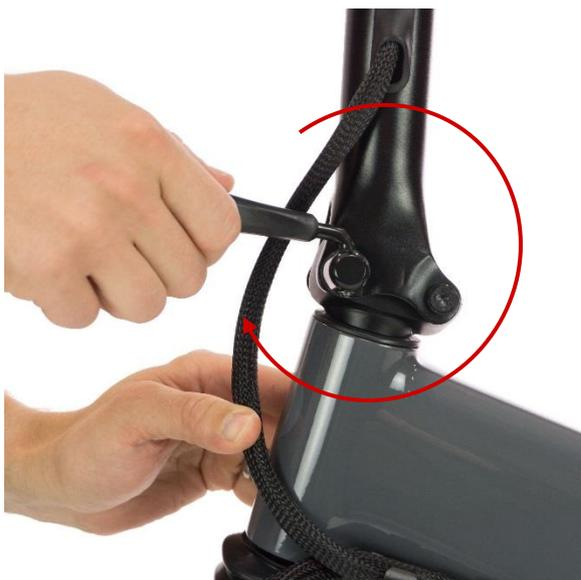
Con la leva a rilascio rapido inserita e in posizione aperta (come mostrato in figura), ruotare in senso orario avendo cura di NON serrarla completamente.
