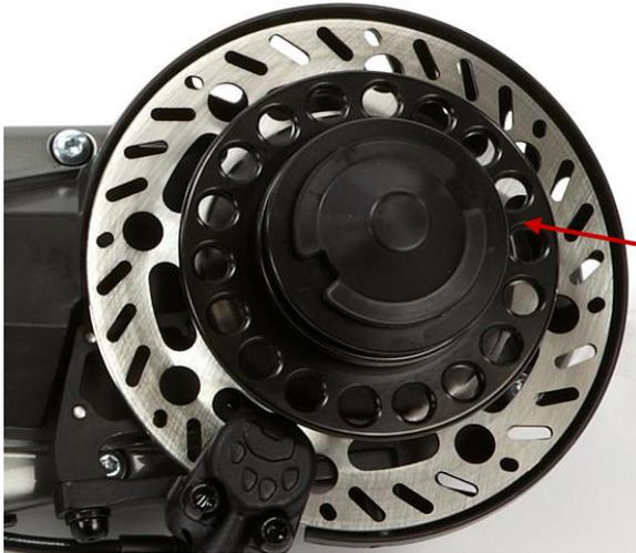
Rimuovere periodicamente la ruota posteriore per verificare la presenza di segni di usura sul mozzo.
