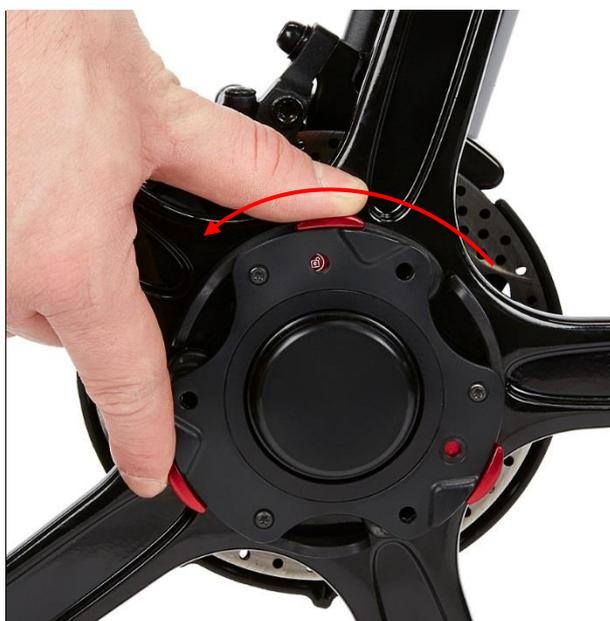
Ruotare il Pitstoplock™ per portarlo alla posizione di sblocco.
