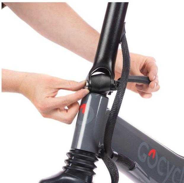
Aprire la leva a rilascio rapido a 90 gradi e ruotare lentamente il dado filettato fino a quando questo non si arresta contro la parte inferiore dello stelo manubrio. Ruotare il dado filettato allineando uno dei fori di quest'ultimo al foro sulla parte inferiore dello stelo, consentendo la reinstallazione del bullone di fissaggio.
