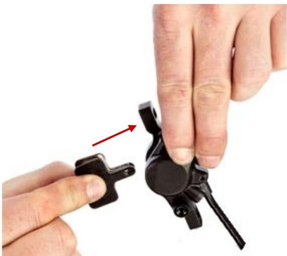
Sostituire le pastiglie dei freni a seconda delle necessità. Ancorare le pastiglie alla molla e reinstallarle all'interno della pinza freno.
