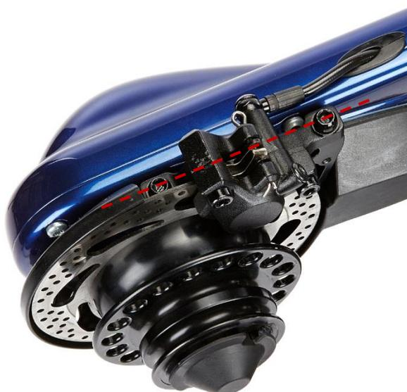
Assicurarsi che la pinza freno sia parallela al rotore del disco una volta serrata, per impedire lo sfregamento del disco.
