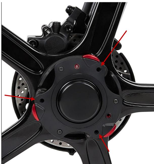
Installare la PitstopWheel® al mozzo, chiudere le tre leve a rilascio rapido e ruotare il Pitstoplock™ rosso portandolo in posizione di blocco. Rimuovere gli occhielli neri in gomma come indicato dalle frecce.
