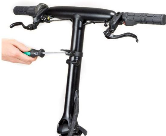
Posizionare la staffa del catadiottro posteriore attorno all'estremità superiore dello stelo, quindi serrare con l'ausilio di un cacciavite per fissare nella posizione mostrata in figura
