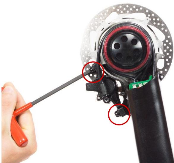
Identificare e rimuovere i bulloni di fissaggio della pinza freno
