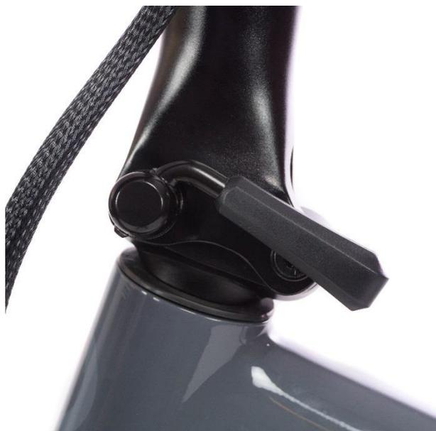
Installare la leva a rilascio rapido (QR) e mantenerla in posizione di chiusura, avendo cura di installarla nel punto corretto (figura).
