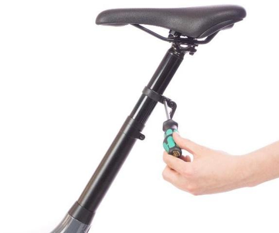
Posizionare la staffa del catadiottro posteriore attorno alla parte superiore del reggisella, quindi serrare con l'ausilio di un cacciavite per fissare nella posizione mostrata in figura
