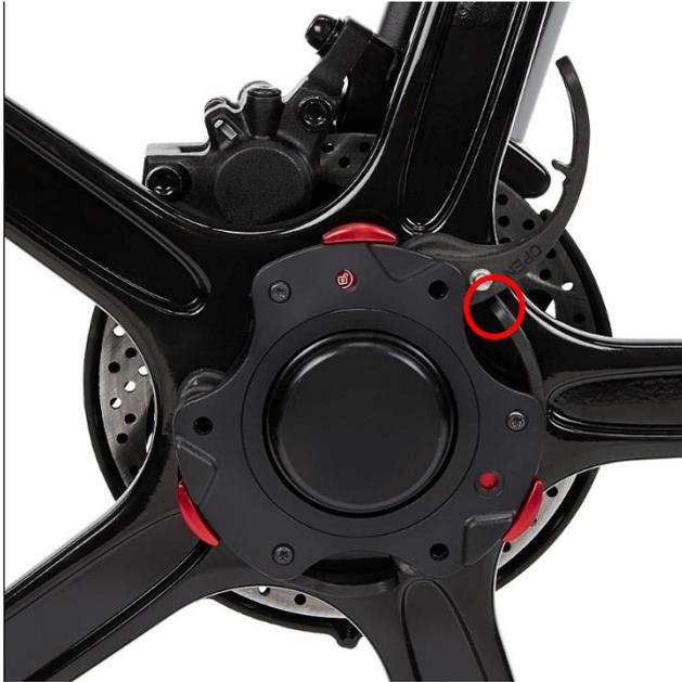
Mantenere due leve a camme in posizione di chiusura e aprire completamente una sola leva, in modo tale che il bordo posteriore di quest'ultima tocchi la leva successiva.
