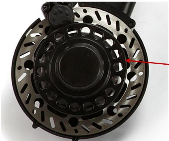
Rimuovere periodicamente la ruota anteriore per verificare la presenza di segni di usura sul mozzo.
