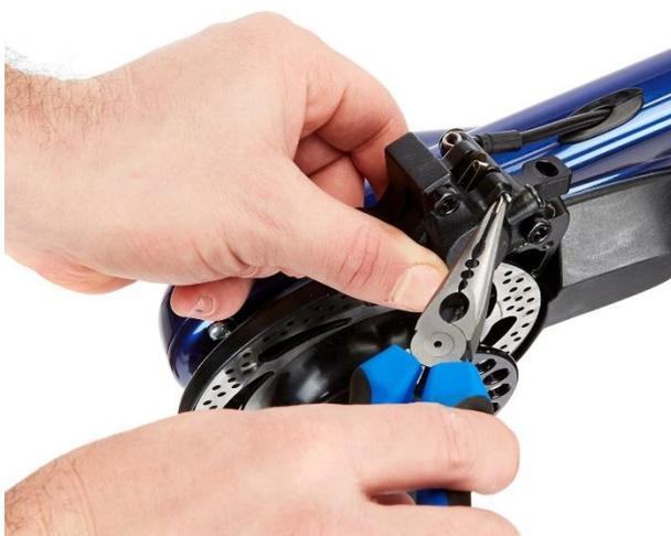
Sostituire le pastiglie dei freni a seconda delle necessità. Ancorare le pastiglie alla molla e reinstallarle all'interno della pinza freno.
