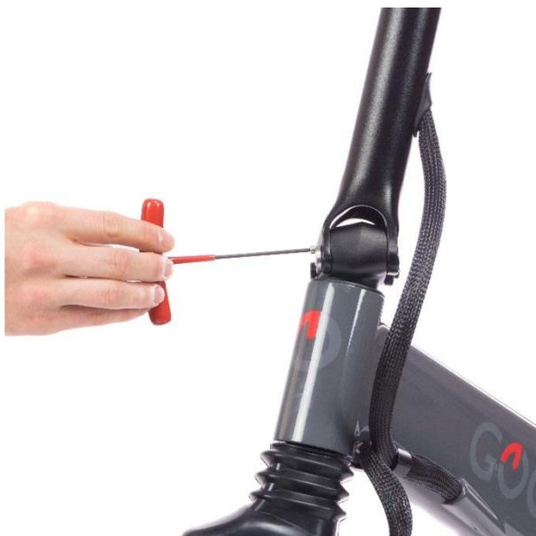
Una volta ultimata la procedura di regolazione, in modo tale che la resistenza di chiusura sia presente negli ultimi 60 gradi del movimento della leva, reinstallare il bullone di fissaggio con chiave a brugola da 2,5 mm.
