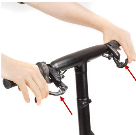
La Gocycle è dotata di freni a disco idraulici anteriori e posteriori, operati tramite le apposite leve ubicate sul manubrio (figura). Prima di utilizzare la bicicletta, è importante acquisire familiarità con i freni e memorizzare la leva utilizzata per azionare il freno anteriore e quella dedicata al freno posteriore. Un utilizzo corretto dei freni avrà l'effetto di rallentare la Gocycle e ottenere un arresto sicuro e controllato della bicicletta.
