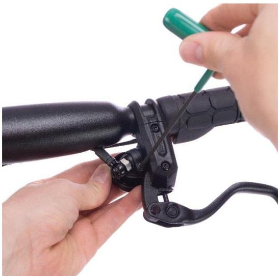
Serrare la staffa di montaggio del campanello a una coppia di 2-3 Nm utilizzando una chiave Torx T10.
