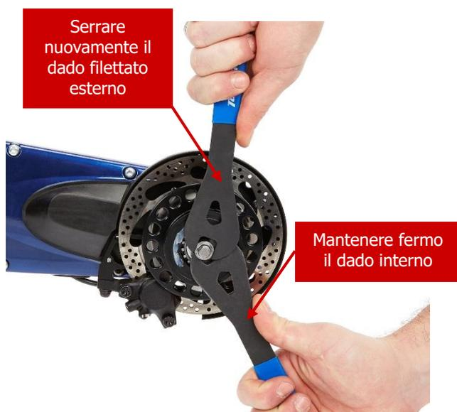
Durante l'operazione, verificare che il mozzo posteriore ruoti in direzione della ruota libera. I dadi delle coppe dei cuscinetti dovrebbero essere serrati fino a quando il "gioco" della ruota non sia superiore a 1 mm in corrispondenza del cerchio, e la ruota è in grado di girare liberamente. L'operazione dovrebbe dar luogo a risultati soddisfacenti. In caso di dubbi, rivolgersi all'[assistenza tecnica Gocycle](#) per ottenere indicazioni.
