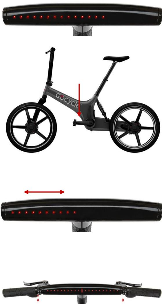
Selezionare *Controllo della presenza del sensore coppia di pedalata*, modo 14.
