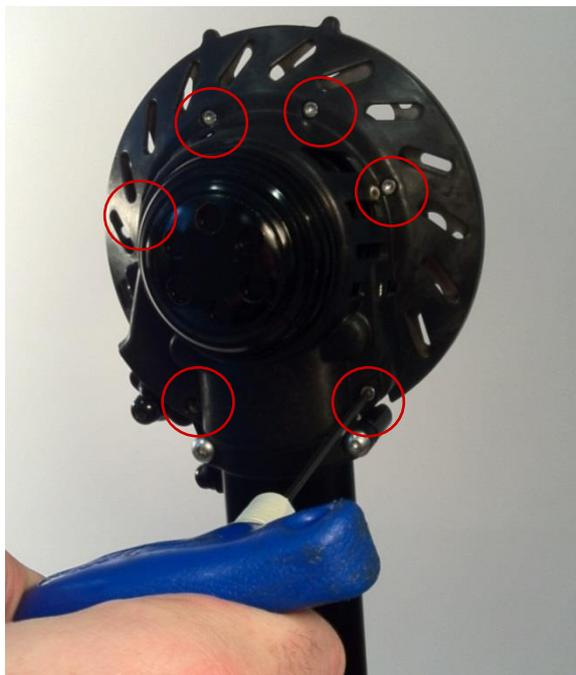
Identificare e rimuovere i sei bulloni di fissaggio del carter motore
