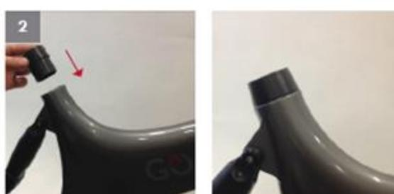
Posizionare la boccola tubo sella nel telaio.
