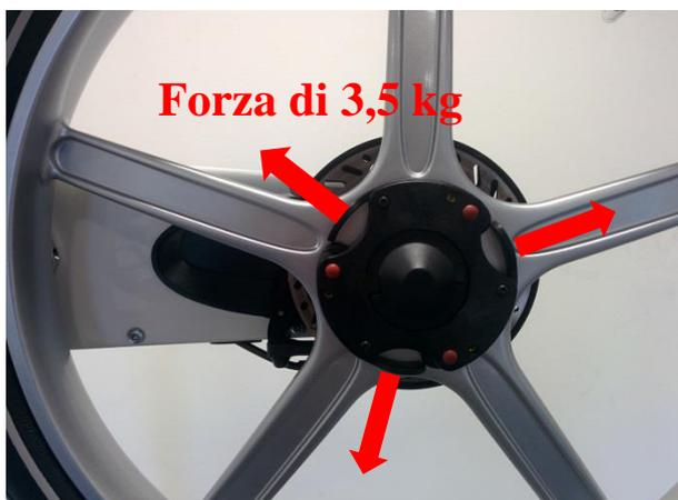
8. Controllo incrociato: la resistenza dovrebbe ora risultare uguale per tutte le leve a camme, con forza di resistenza di 3-5 kg per l'apertura di ciascuna leva.
