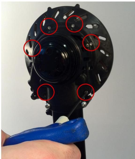
Reinstallare i sei bulloni di fissaggio del carter motore. Serrare a una coppia di 3-4 Nm.
