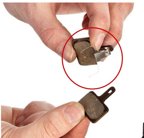
Sostituire le pastiglie dei freni a seconda delle necessità prima del riassettaggio.
