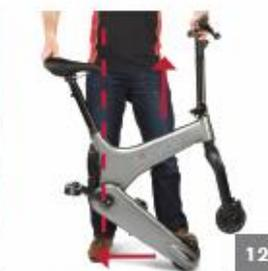
12 Muovere la trasmissione Cleandrive verso il basso come mostrato in figura (consiglio: tenere ferma la trasmissione Cleandrive applicando una lieve pressione col piede mentre si solleva il telaio)
