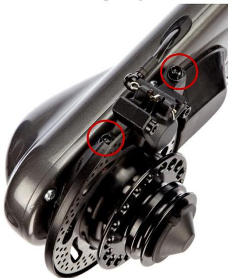
Identificare i due bulloni di fissaggio della pinza freno posteriore (figura).
