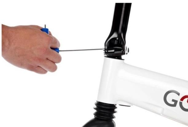
Allentare il bullone di fissaggio del dado filettato con chiave a brugola da 2,5 mm
