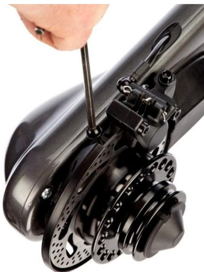
Reinstallare entrambi i bulloni di fissaggio della pinza freno. Serrare a una coppia di 6-8 Nm.
