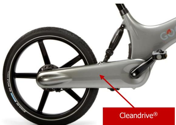
I componenti interni della trasmissione Cleandrive® non necessitano di ispezione, pulizia o lubrificazione regolare.
