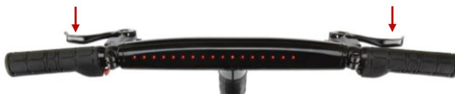
La Gocycle è dotata di freni a disco idraulici anteriori e posteriori, operati tramite le apposite leve ubicate sul manubrio (figura). Prima di utilizzare la bicicletta, è importante acquisire familiarità con i freni e memorizzare la leva utilizzata per azionare il freno anteriore e quella dedicata al freno posteriore. Un utilizzo corretto dei freni avrà l'effetto di rallentare la Gocycle e ottenere un arresto sicuro e controllato della bicicletta.
