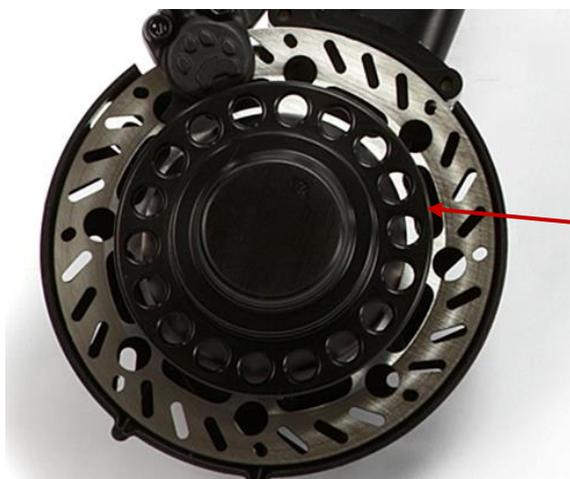
Rimuovere periodicamente la ruota anteriore per verificare la presenza di segni di usura sul mozzo.
