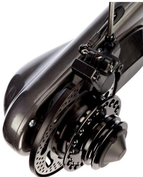
Rimuovere il bullone anteriore della pinza freno con l'ausilio di una chiave a brugola, come mostrato in figura.
