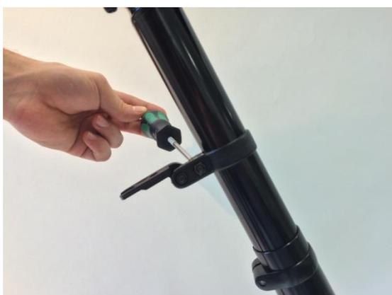
Posizionare la staffa del catadiottro posteriore attorno alla parte superiore del reggisella, quindi serrare con l'ausilio di un cacciavite per fissare nella posizione mostrata in figura
