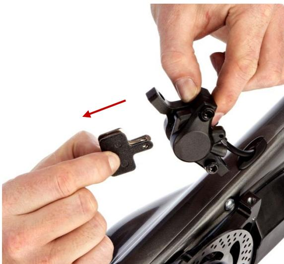
Sostituire le pastiglie dei freni a seconda delle necessità. Ancorare le pastiglie alla molla e reinstallarle all'interno della pinza freno.
