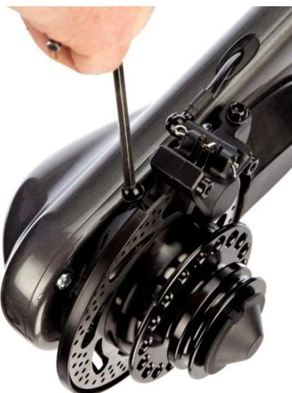
Rimuovere il bullone posteriore della pinza freno con l'ausilio di una chiave a brugola, come mostrato in figura.
