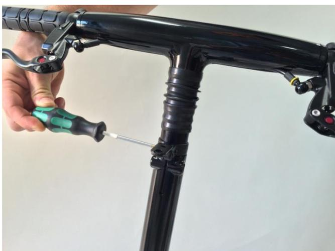
Posizionare la staffa del catadiottro posteriore attorno all'estremità superiore dello stelo, quindi serrare con l'ausilio di un cacciavite per fissare nella posizione mostrata in figura
