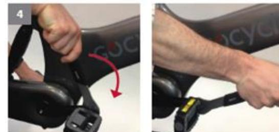
Utilizzando la chiave fissa da 15 mm e tenendo fermo la pedaliera sinistra, serrare completamente a una coppia di 35-40 Nm.
