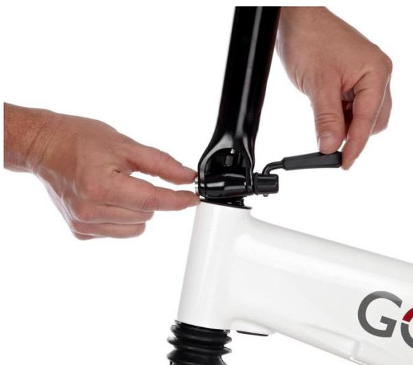
Installare la leva a rilascio rapido e mantenerla in posizione di chiusura, avendo cura di installarla nel punto corretto (figura).
