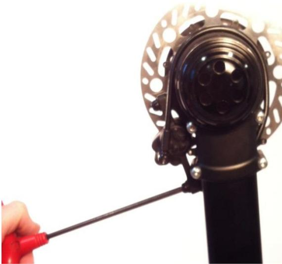
Reinstallare la pinza freno anteriore. Serrare i bulloni di fissaggio della pinza freno a una coppia di 6–8 Nm.
