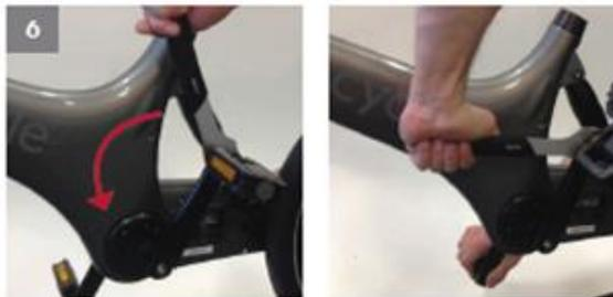
Utilizzando la chiave fissa da 15 mm e tenendo fermo la pedaliera destra, serrare completamente a una coppia di 35-40 Nm.
