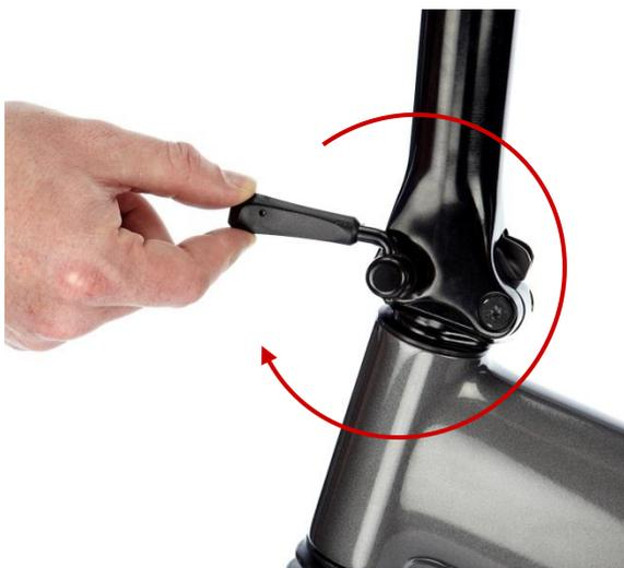
Una volta inserita, serrare la leva ruotandola in senso orario.
