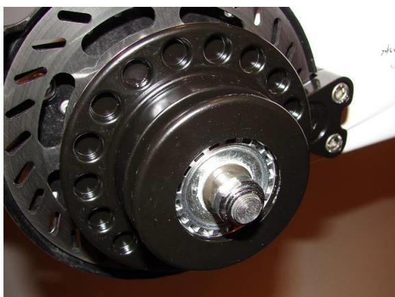
Regolazione delle coppe dei cuscinetti del cambio epicicloidale sul mozzo posteriore
