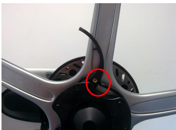
3. Mantenere due leve a camme in posizione di chiusura e aprire completamente una sola leva, in modo tale che il bordo posteriore di quest'ultima tocchi la leva successiva.
