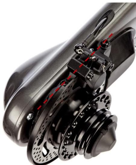
Assicurarsi che la pinza freno sia parallela al rotore del disco una volta serrata.
