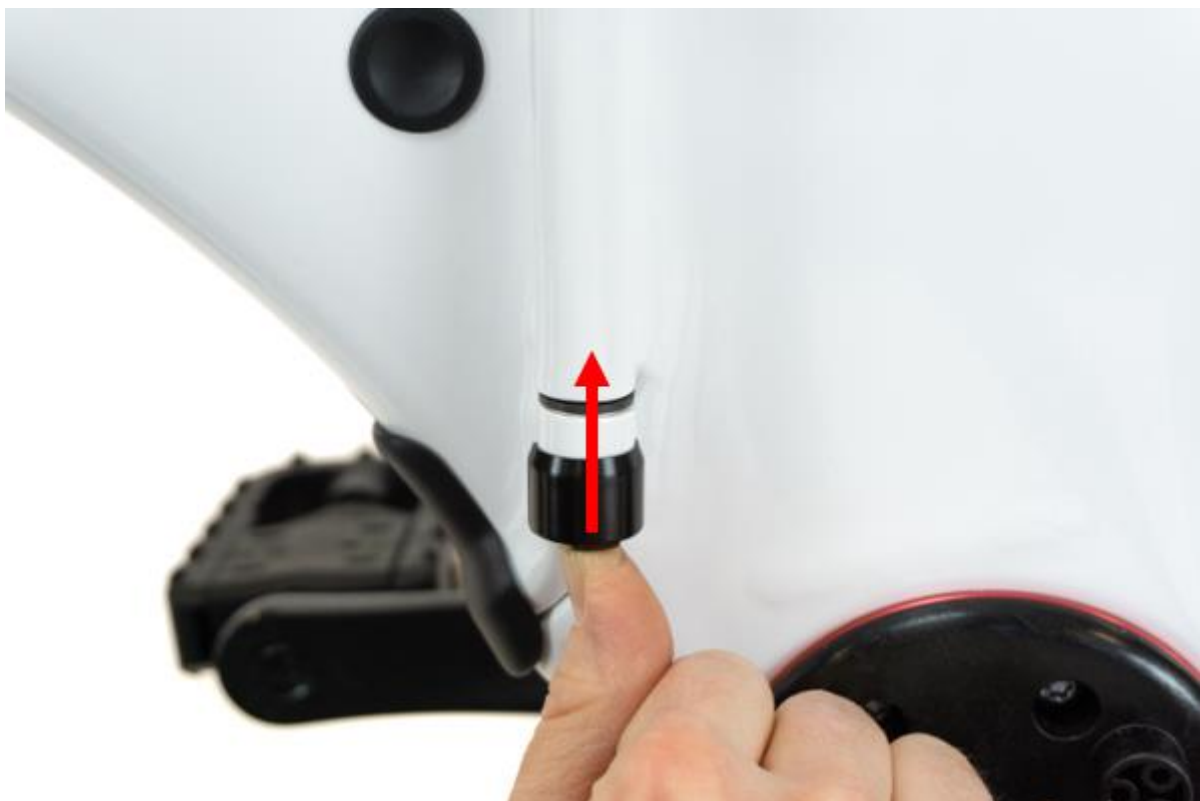
Montage des unteren Scharnierbolzen-Halteclips - wie gezeigt, fest nach oben drücken
