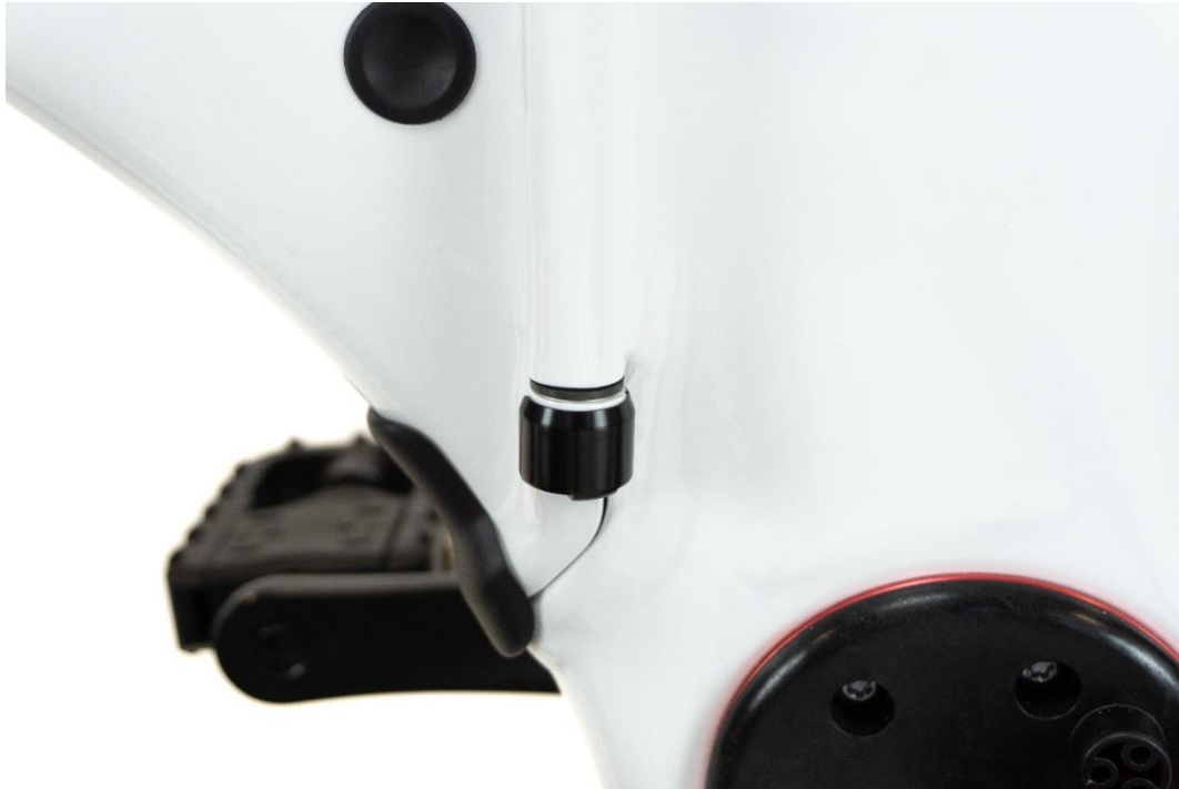
Halteklammer der unteren Scharnierschraube installiert - richtig.
