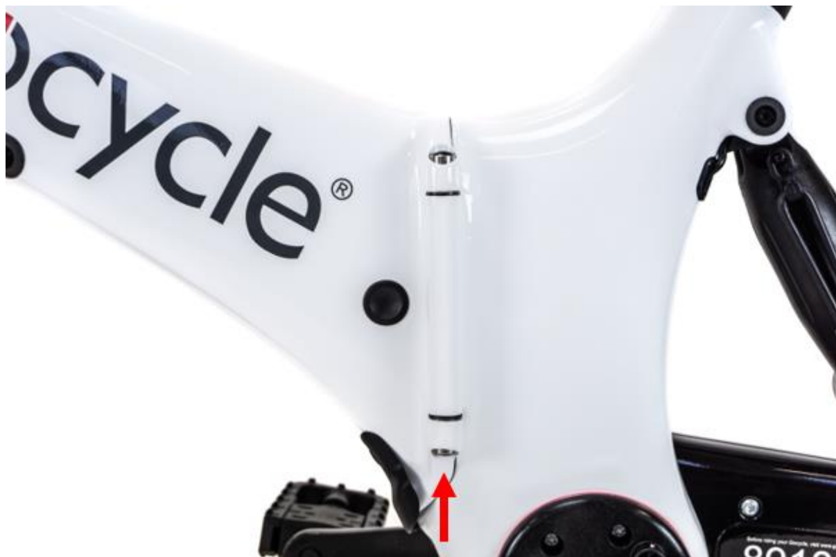
Ubicación del perno de la bisagra inferior del cuadro
