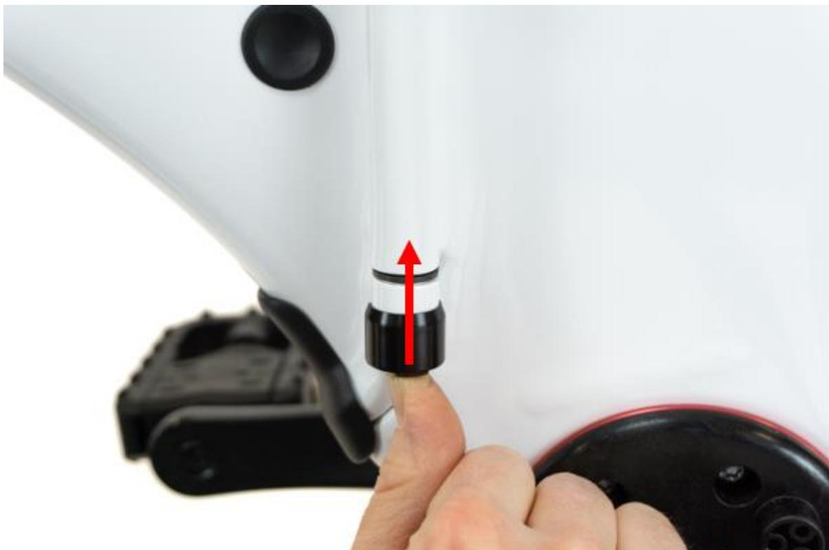
*Pose du clip de retenue du boulon d'articulation inférieur du cadre : le fichez fermement en place en le poussant vers le haut, comme sur l'illustration*
