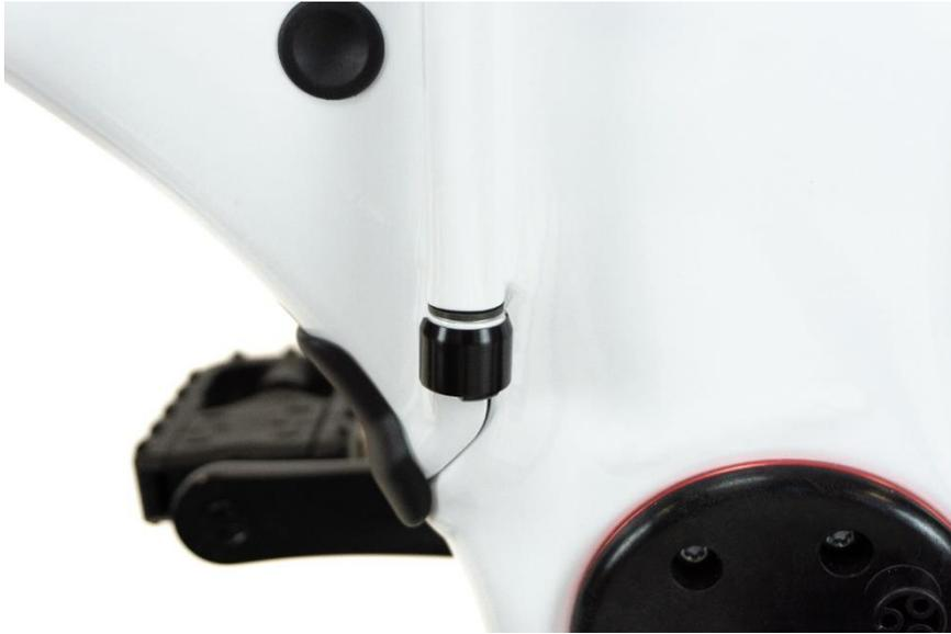
*Clip de retenue du boulon d'articulation inférieur du cadre posé correctement.*
