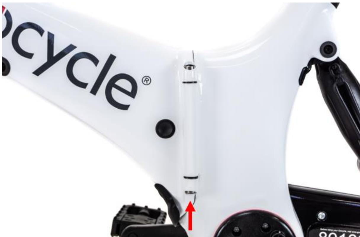
*Emplacement du boulon d'articulation inférieur du cadre*
