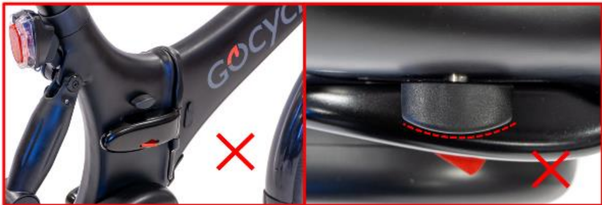
Diese gebogene Rändelschraube muss ersetzt werden. Nicht OK.
