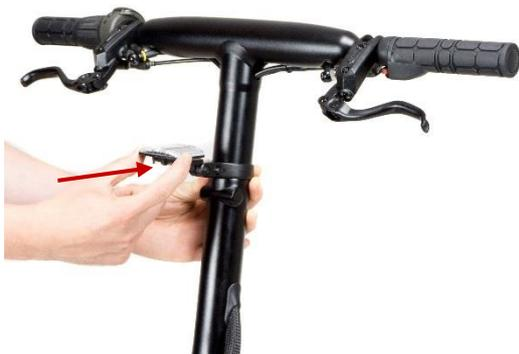
Setzen Sie den vorderen (weißen) Reflektor auf den Haltebügel, wie abgebildet. Stellen Sie sicher, dass der Reflektor vollständig in dem Haltebügel eingerastet ist.
