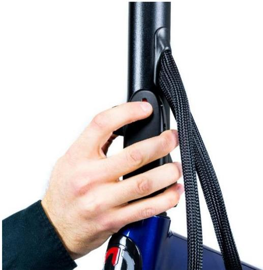
Halten Sie die rote Verriegelung gedrückt und ziehen Sie die Lenkerverriegelung wie abgebildet auf.
