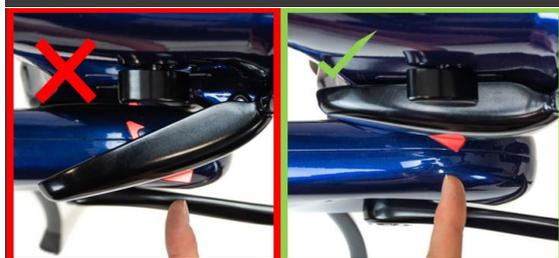
Drücken Sie bei geschlossener schwarzer Verriegelung die rote Verriegelung mehrmals mit einem Finger.
