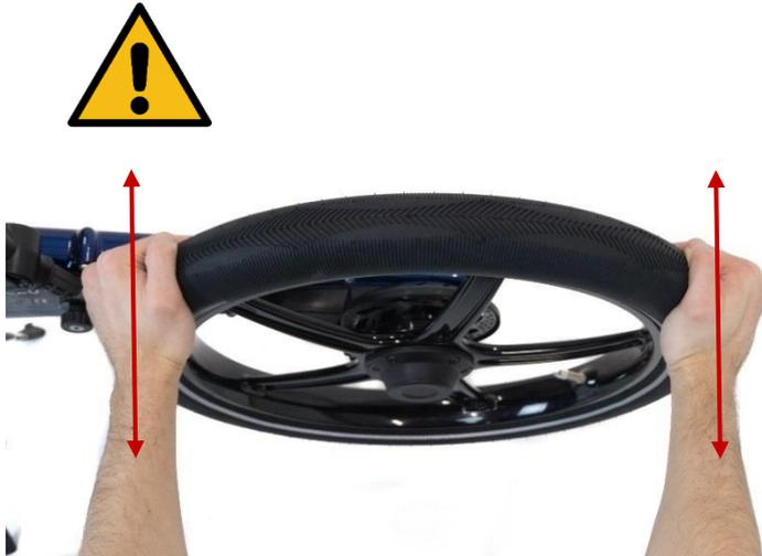
Um zu prüfen, ob eine Einstellung erforderlich ist, bewegen Sie das Hinterrad an der Felge mit leichtem Druck ach links und rechts.
