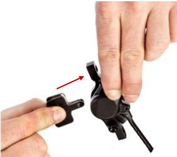
Wechseln Sie die Bremsbeläge nach Bedarf. Drücken Sie sie mit der Feder zusammen und bauen Sie sie wieder in den Bremssattel ein.
