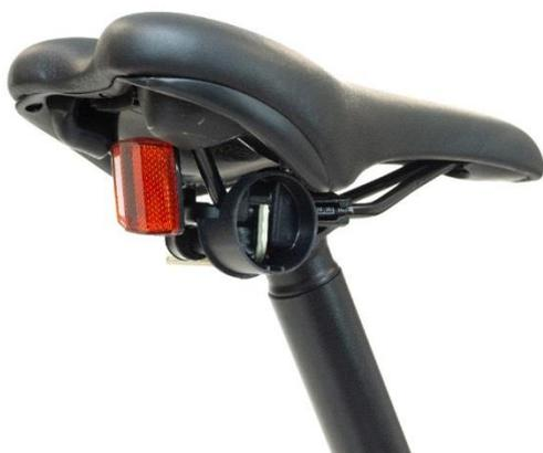
Der Reflektor ist unter dem Sattel vormontiert.
