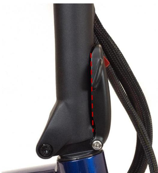
Schließen Sie die Lenkerverriegelung, wie abgebildet. Die Verriegelung sollte sich zwischen 25 und 35 mm von der vollständig geschlossenen Position aus fest anfühlen. Siehe Abschnitt 5 zur Wartung und Einstellung.
