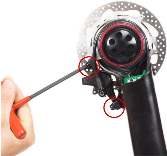
Entfernen Sie die zwei Bremssattel-Befestigungsschrauben.
