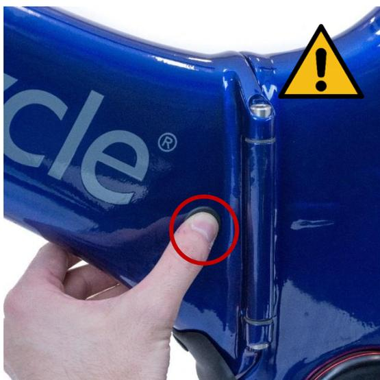
Schalten Sie den Akku aus, indem Sie den Ein- / Ausschalter gedrückt halten. Halten Sie die Taste mindestens eine halbe Sekunde lang gedrückt, bevor Sie sie loslassen.
