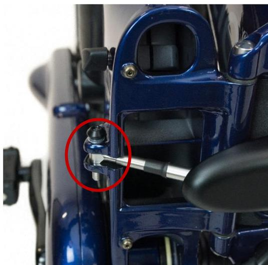
Suchen Sie den Sicherungsbolzen der Rahmenverriegelung wie abgebildet.
