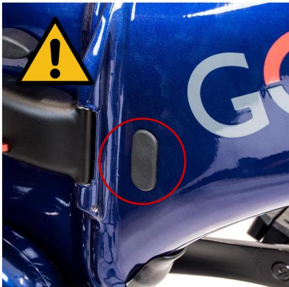
OPTIMALE VORGEHENSWEISE! Bei voll aufgeladenem Akku und von der Netzstromversorgung getrenntem Ladegerät schalten Sie den Akku aus. Halten Sie die Taste mindestens eine halbe Sekunde lang gedrückt, bevor Sie sie loslassen. Weitere Informationen finden Sie in Abschnitt 4.5.2.
