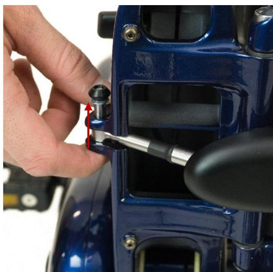
Drücken Sie den Sicherungsbolzen der Rahmenverriegelung in die dargestellte Richtung.
