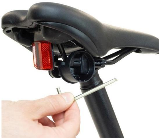
Ziehen Sie den Inbusschlüssel aus dem Werkzeughalter.
