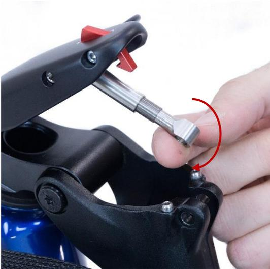
Wenn der Schnappverschluss zu festgängig ist, drehen Sie die Abstandsstrebe im Uhrzeigersinn um eine halbe Umdrehung, um sie zu verkürzen.
