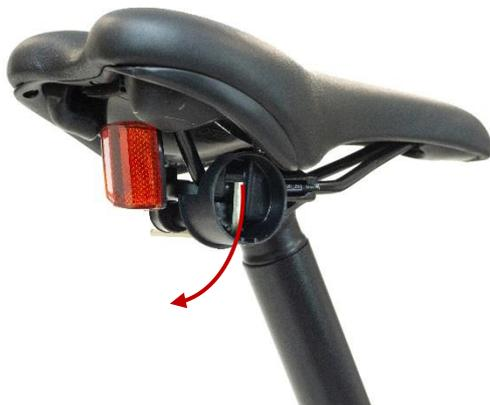
Lösen Sie das Multifunktionswerkzeug wie abgebildet vom Sattel.
