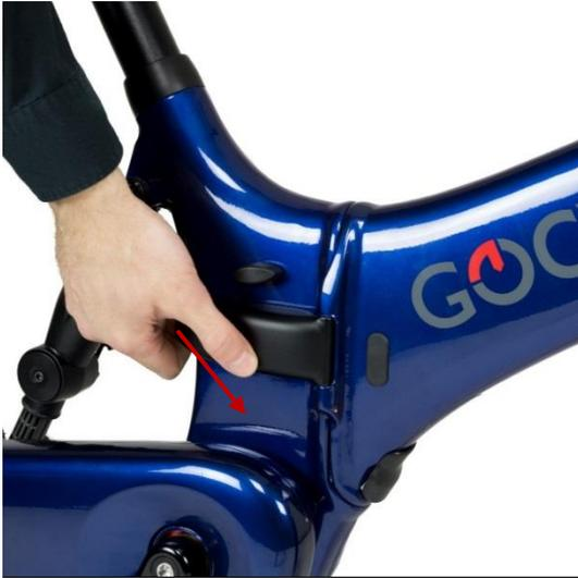
Halten Sie die rote Verriegelung gedrückt und ziehen Sie die Verriegelung wie abgebildet auf.
