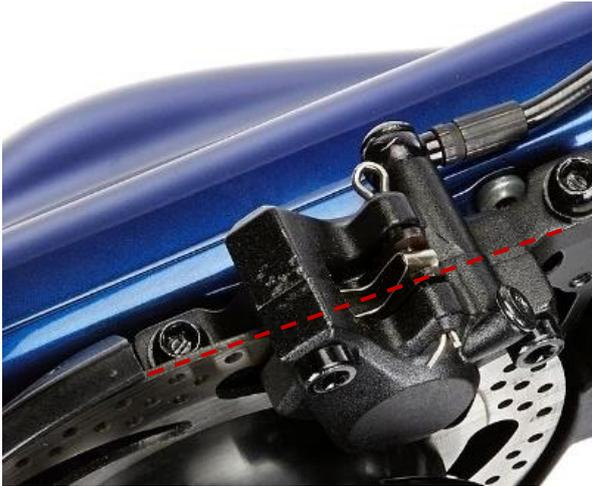
Stellen Sie sicher, dass der Bremssattel nach dem Festziehen parallel zur Bremsscheibe steht, um ein Scheuern an der Scheibe zu verhindern.
