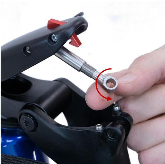
Wenn der Schnappverschluss zu leichtgängig ist, drehen Sie die Abstandsstrebe gegen den Uhrzeigersinn um eine halbe Umdrehung, um sie zu verlängern.
