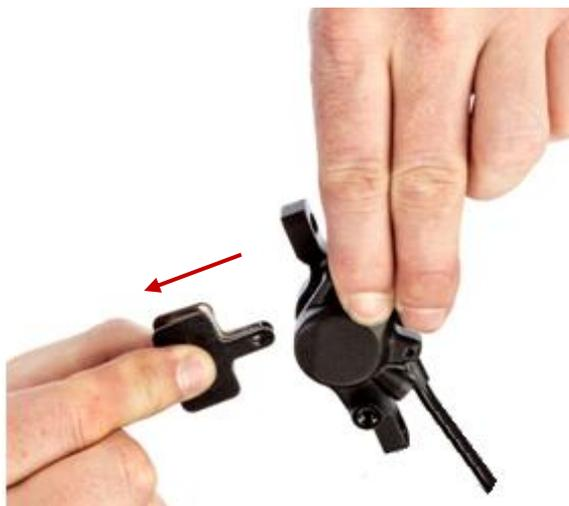
Drücken Sie die beiden Bremsbeläge zusammen und ziehen Sie sie aus dem Bremssattel heraus.
