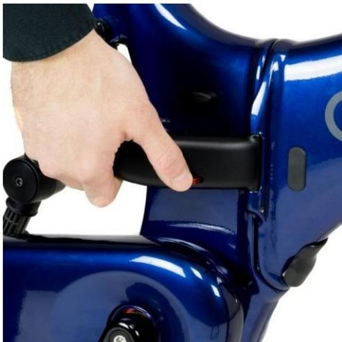
Drücken Sie auf den roten Riegel und öffnen Sie die Rahmenverriegelung, wie abgebildet.
