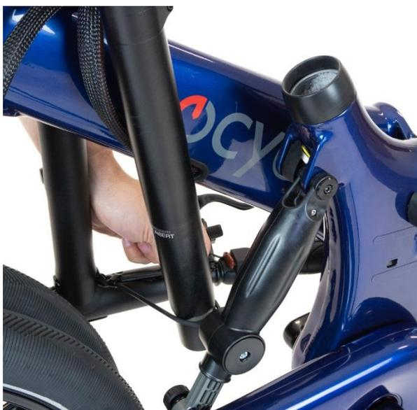
Öffnen Sie den Falzgummi und setzen Sie die Sattelstütze ein.
