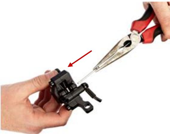
Setzen Sie den Splint wieder ein, um die Bremsbeläge in ihrer Solllage zu befestigen.
