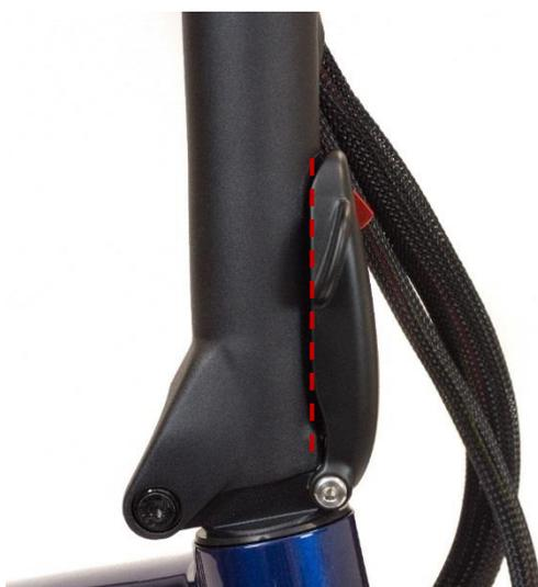
Schließen Sie den Schnappverschluss des Vorbaus. Er sollte sich mit einem Abstand von 25-35 mm vom Vorbau fest anfühlen. Ist dies nicht der Fall, wiederholen Sie die obigen Schritte nach Bedarf.
