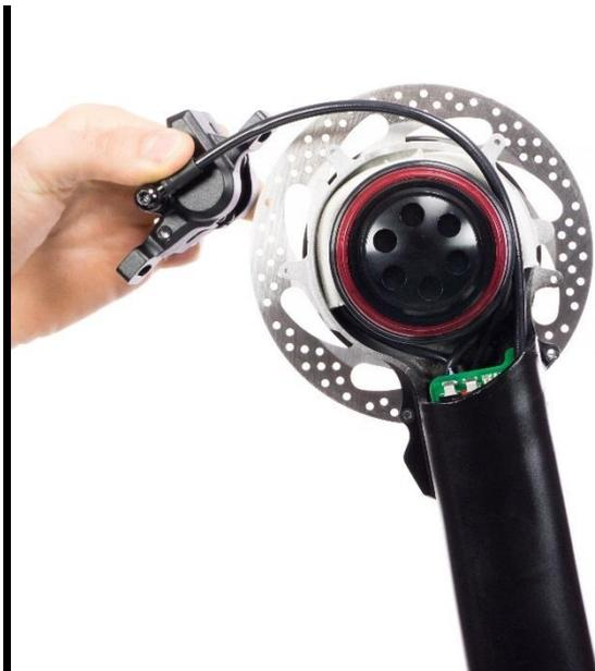
Ziehen Sie den Bremssattel von der Bremsscheibe ab.
