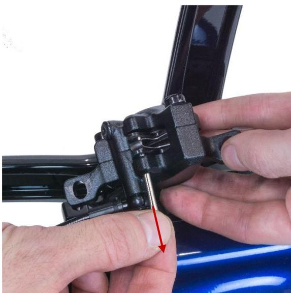
Ziehen Sie den zusammengedrückten Splint mit der Zange heraus.
