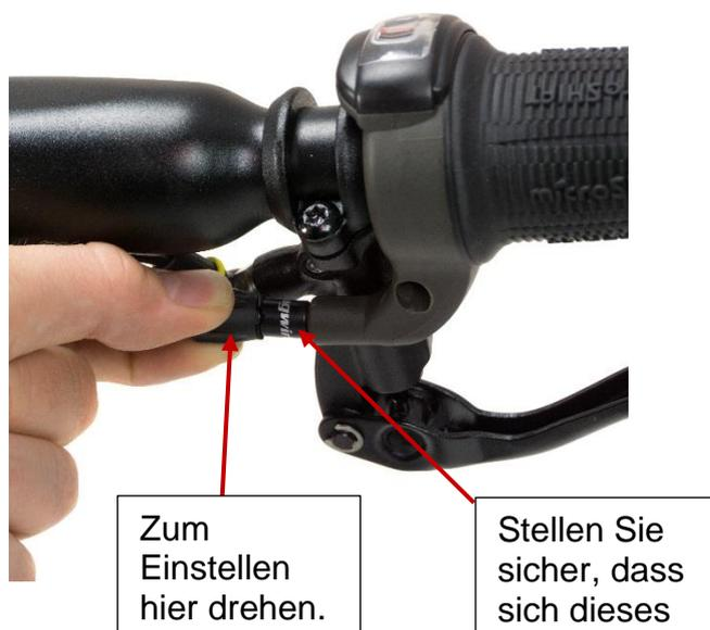
Drehen Sie den Schaltzug-Einsteller im oder gegen den Uhrzeigersinn, um den Schaltzug einzustellen. Drehen Sie im Uhrzeigersinn (lockert das Kabel), wenn Ihre Gangwahl das Gocycle in einen höheren Gang als den von Ihnen gewählten schaltet und gegen den Uhrzeigersinn (spannt das Kabel), wenn Ihre Gangwahl das Gocycle in einen niedrigeren Gang als den von Ihnen gewählten schaltet.
