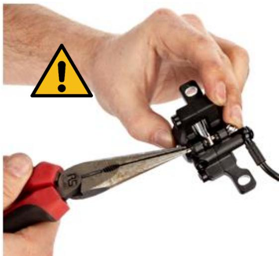
Biegen Sie den Splint mit einer Zange auf, so dass er ihn in seiner Einbaulage gesichert wird.
