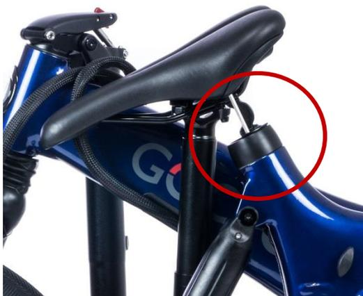
Schieben Sie das Sattel-Multifunktionswerkzeug wie abgebildet in den Sattelstützenkragen ein.
