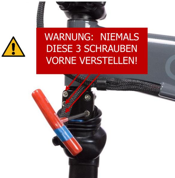
Stellen Sie sicher, dass die Vorderradgabel und der Lenker richtig stehen und ziehen Sie die beiden Gabelkopfschrauben mit 10-12 Nm an.
