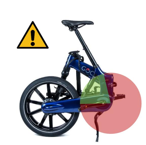
Drehen Sie die Pedale so, dass sich das rechte Pedal im grün gekennzeichneten Bereich befindet.
