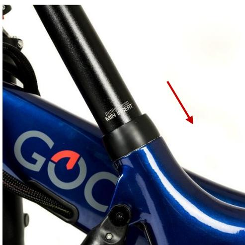
Stecken Sie die Sattelstütze in den Rahmen, wie abgebildet.
