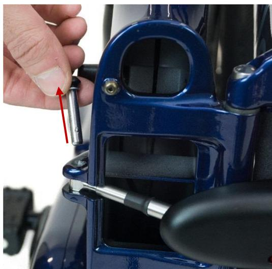
Entfernen Sie den Sicherungsbolzen der Rahmenverriegelung, wie abgebildet.
