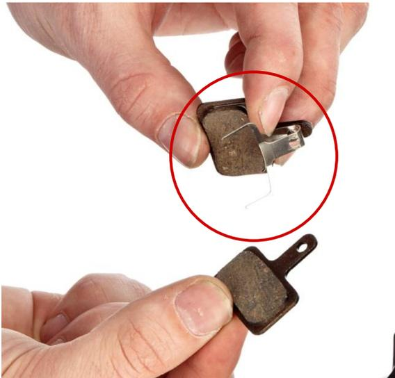
Wechseln Sie die Bremsbeläge nach Bedarf, bevor Sie den Bremssattel wieder zusammenbauen.
