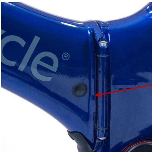
Um den Akku auszuschalten, halten Sie die Taste mindestens ½ Sekunde lang gedrückt. Die LEDs des Lenker-Displays und die LEDs auf der Rückseite des Akkus erlöschen.
