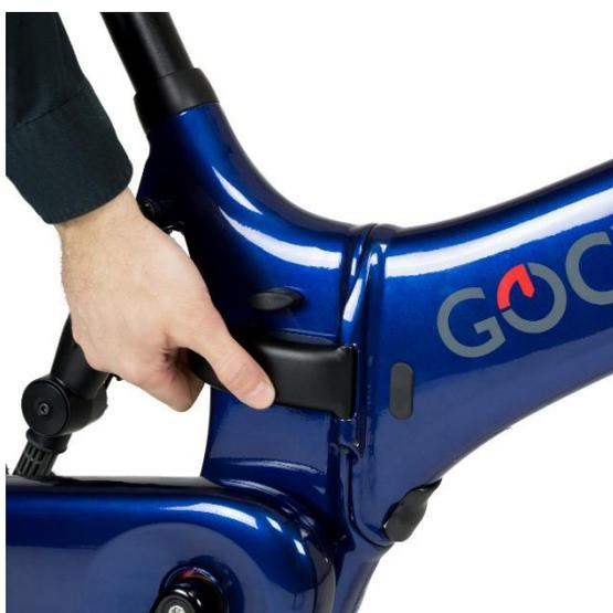
Drücken Sie auf die rote Verriegelung und öffnen Sie den Riegel, wie abgebildet.
