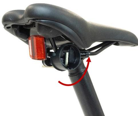
Drehen Sie das Sattelstützen-Multifunktionswerkzeug und klemmen Sie es wie abgebildet an die Sattelschiene.
