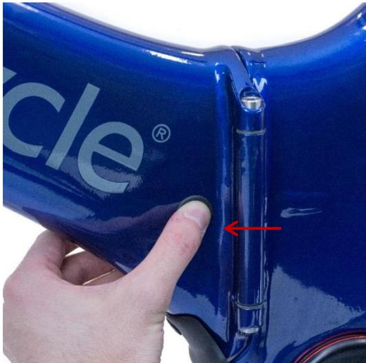
Tippen Sie einmal auf die Taste (weniger als eine halbe Sekunde). Dadurch wird der Akku eingeschaltet.
