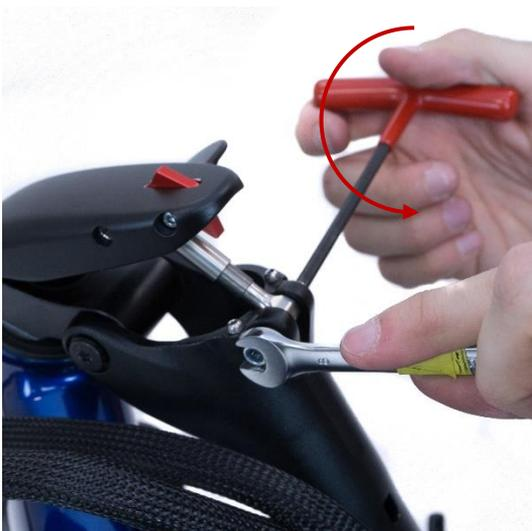
Bringen Sie die Sicherungsschraube wieder in den Vorbau und Ziehen Sie sie wie abgebildet mit 3-4 Nm fest.
