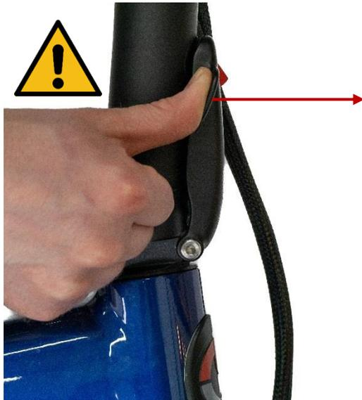
Drücken Sie den Schnappverschluss fest in die gezeigte Richtung, um zu überprüfen, ob der Riegel eingerastet ist. Prüfen, ob die Verriegelungen eingerastet sind. Der Schnappverschluss darf sich nicht öffnen, wenn man kräftig in die gezeigte Richtung drückt.
