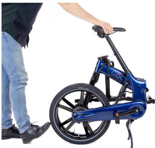
Wenn Sie das Rollen des Gocycle beendet haben, setzen Sie einen Fuß hinter das Rad und kippen Sie das Gocycle nach vorne, sodass es auf dem Ständer und den Rädern steht.
