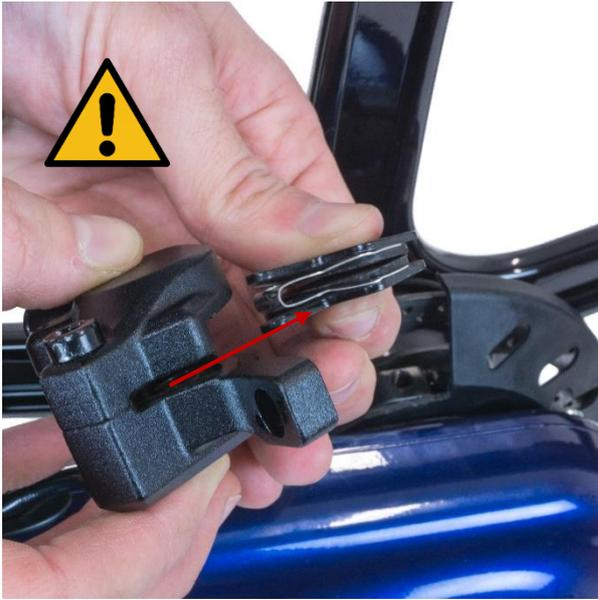
Drücken Sie die beiden Bremsbeläge zusammen und ziehen Sie sie aus dem Bremssattel heraus.
