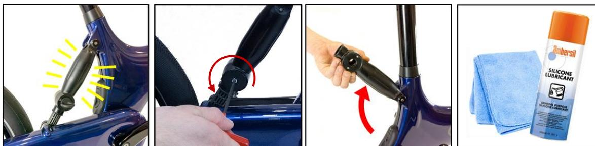
Sprühen Sie eine großzügige Menge Silikonschmiermittel in das Ende des Lockshock™ und entfernen Sie alles Übergespritzte oder Verschüttete mit einem Tuch. Warten Sie 5 Minuten, während sich das Lockshock™ in senkrechter Position befindet, damit sich das Schmiermittel nach unten verteilen kann. Montieren Sie den Lockshock-Kolben und den Falzgummi wieder, um den Vorgang abzuschließen.
