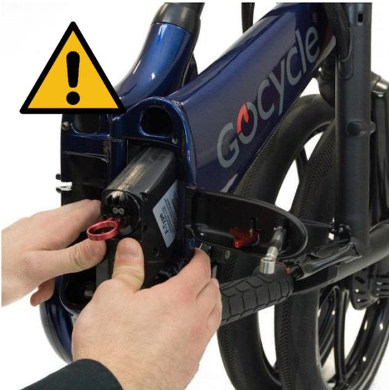
Stecken Sie den ausgeschalteten Akku wie abgebildet in den Rahmen.
