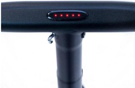
Wenn das Gocycle eingeschaltet ist, leuchtet das Lenker-Display und zeigt die aktuelle Batterielebensdauer an. Eine einzelne LED repräsentiert ungefähr 20% der Batteriekapazität.
