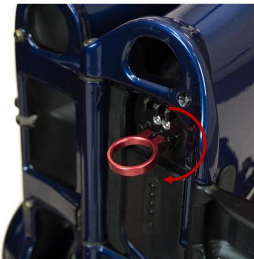
Drehen Sie den Ring wie abgebildet um 180°, sodass sich der Batteriering unten befindet. Dadurch wird der Akku im Rahmen gelöst.
