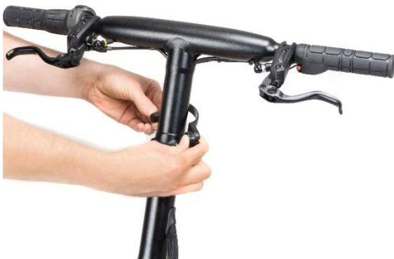
Öffnen Sie den Haltebügel des Reflektors, wie abgebildet.
