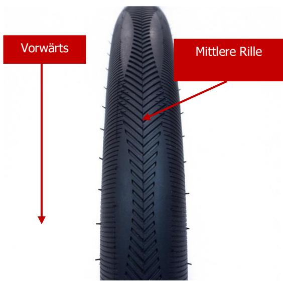
Reifenmontage und Laufrichtung des Profils
