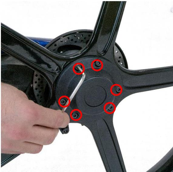
Lösen Sie die sechs Schrauben, mit denen das Hinterrad befestigt ist.
