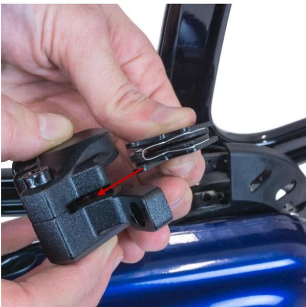
Wechseln Sie die Bremsbeläge nach Bedarf. Drücken Sie sie mit der Feder zusammen und bauen Sie sie wieder in den Bremssattel ein.
