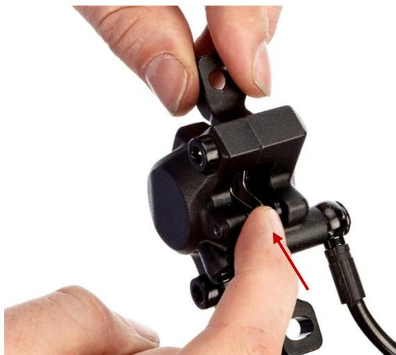
Drücken Sie an der Oberseite der Bremszange vorsichtig auf die Bremsbeläge, wie abgebildet.
