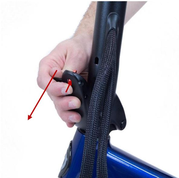
Öffnen Sie die Spindelverriegelung, indem Sie in der gezeigten Richtung auf die Verriegelung drücken.
