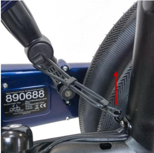
Haken Sie den Faltgummi aus dem Lenkervorbauhaken.
