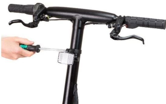
Stellen sie den Haltebügel so ein, dass der Rückstrahler senkrecht steht und ziehen Sie die Schraube mit 4-6 Nm fest.
