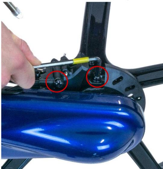
Entfernen Sie die beiden hinteren Bremssattelschrauben aus, wie abgebildet.
