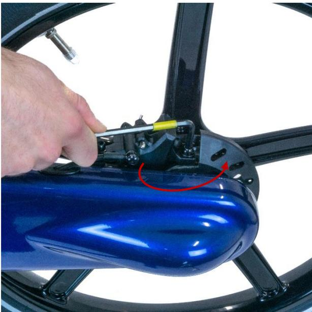
Erneuern Sie die beiden Schrauben des Bremssattels Ziehen Sie sie mit 6-8 Nm fest.
