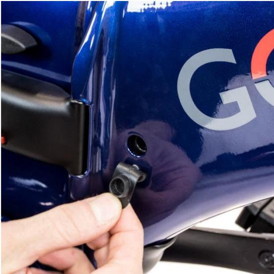
Öffnen Sie die Gummiabdeckung am Ladeanschluss, wie abgebildet.
