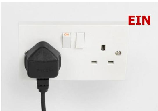
Schließen Sie den Stecker des Ladegeräts an eine Netzsteckdose an und schalten Sie diese ein, falls erforderlich.
