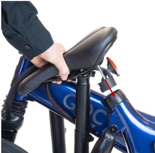
Bringen Sie das Sattel-Multifunktionswerkzeug über den Sattelstützenkragen.
