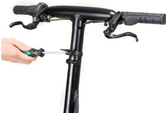
Legen Sie den Haltebügel um den Vorbau und ziehen Sie ihn mit einem Schraubendreher fest.
