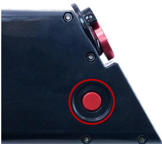
**OPTIMALE VORGEHENSWEISE!** Bei voll aufgeladenem Akku und von der Netzstromversorgung getrenntem Ladegerät schalten Sie den Akku aus. Weitere Informationen finden Sie in Abschnitt **Schalter Batterie Ein/Aus** Ein. Es wird empfohlen, das Gocycle keinesfalls länger als 24 Stunden ohne Unterbrechung aufzuladen.
