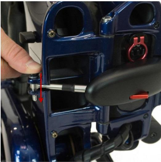
Setzen Sie die Rahmenverriegelung wie abgebildet wieder zusammen. Stellen Sie dabei sicher, dass der Sicherungsbolzen in der gezeigten Position vollständig eingerastet ist.
