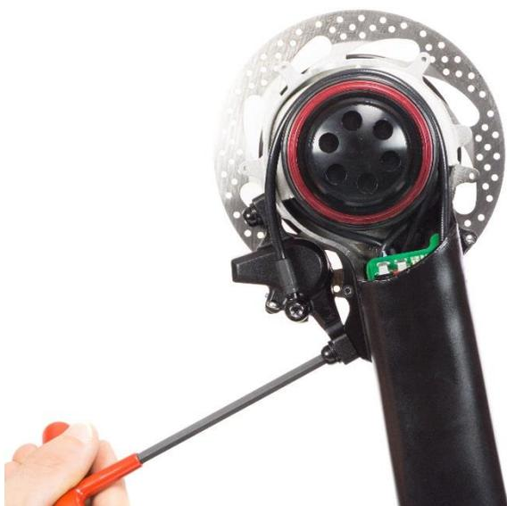
Bringen Sie den Vorderrad-Bremssattel wieder an. Ziehen Sie die Bremssattel-Befestigungsschrauben auf 6 – 8 Nm fest.
