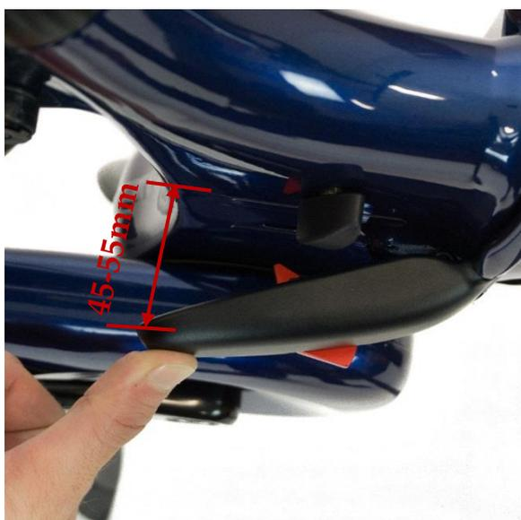
Schließen Sie die Rahmenverriegelung, wie abgebildet. Die Verriegelung sollte sich zwischen 45 und 55 mm von der vollständig geschlossenen Position aus fest anfühlen. Siehe Einstellen des Rahmenverriegelung.
