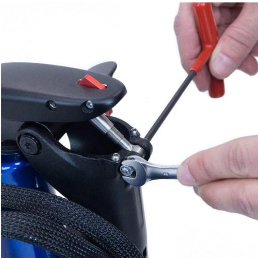
Lösen Sie die Mutter und die Sicherungsschraube mit einem 4-mm-Inbusschlüssel und einem 8-mm-Gabelschlüssel.
