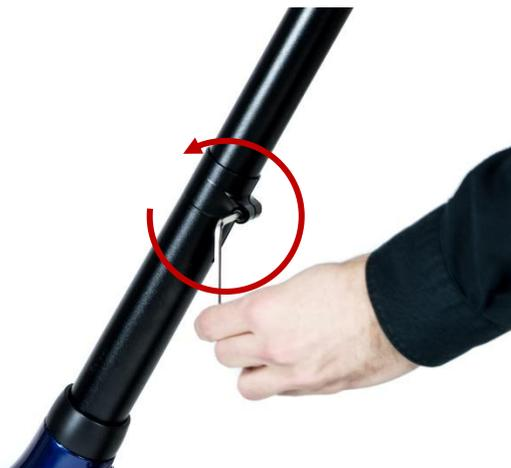
Lösen Sie die Schraube der Sattelstütze mit dem Inbusschlüssel, wie abgebildet.
