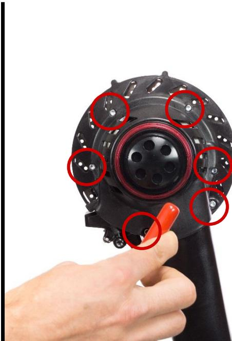
Entfernen Sie die sechs Befestigungsschrauben an der Motorabdeckung (siehe Abbildung).
