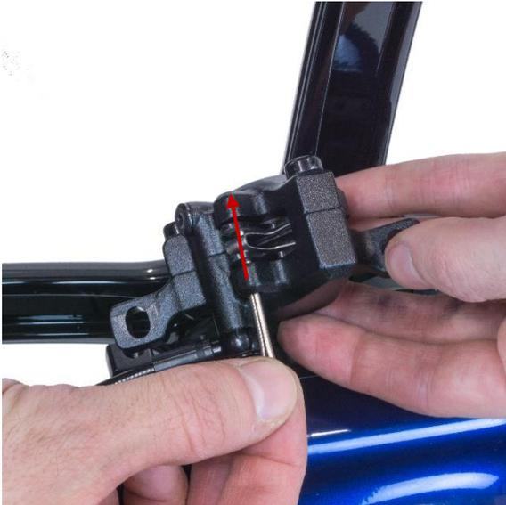
Setzen Sie den Splint wieder ein, um die Bremsbeläge in ihrer Solllage zu befestigen.
