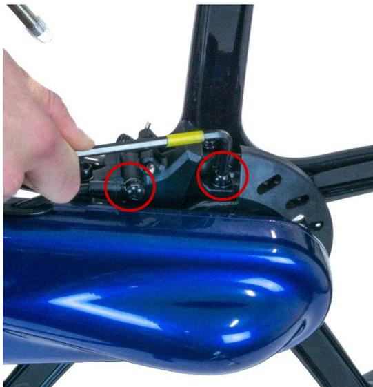
Repérez et retirez les deux boulons de fixation de l'étrier arrière, comme sur l'illustration.
