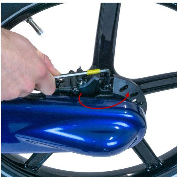
Remettez en place les deux boulons de fixation de l'étrier. Serrez à un couple de 6-8 Nm.
