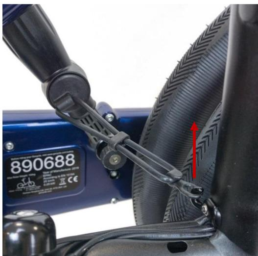
Déclippez la sangle de pliage du crochet de la potence du guidon.
