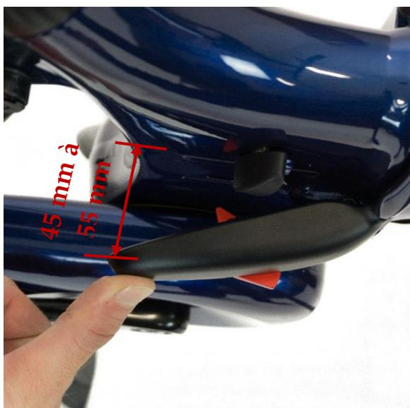
Fermez le loquet du cadre comme sur l'illustration. Le loquet doit commencer à présenter de la résistance quand il se trouve entre 45 mm et 55 mm d'écart de la position complètement fermée. Voir 5.12 Réglage du loquet du cadre
