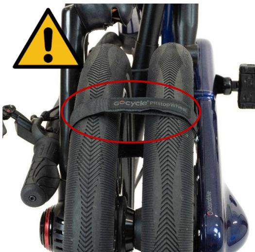
**AVERTISSEMENT !** La sangle de rangement doit être utilisée lors du levage, du rangement ou du transport du Gocycle.
