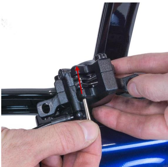
Remettez en place la goupille fendue pour fixer les plaquettes de frein en position.
