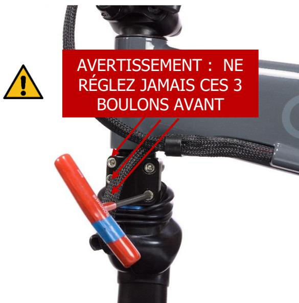
En veillant à ce que la fourche avant et le guidon soient alignés, serrez les deux boulons de tête de fourche à 10-12 Nm.
