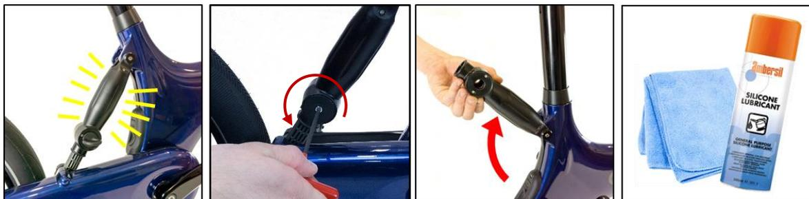
Pulvérisez une quantité généreuse de lubrifiant silicone dans l'extrémité du dispositif Lockshock™ et essuyez tout excès ou déversement avec un chiffon. Maintenez pendant 5 minutes le dispositif Lockshock™ à la verticale pour permettre au lubrifiant de s'écouler vers le bas. Réinsérez le plongeur Lockshock et remettez la sangle de pliage pour finir.
