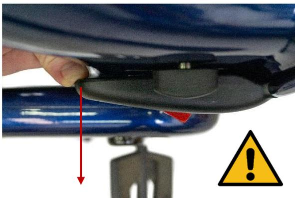
Poussez fortement dans le sens indiqué pour vérifier que le loquet est verrouillé. Vérifiez que les loquets sont verrouillés. Le loquet ne doit normalement pas s'ouvrir quand on appuie fort dessus dans le sens indiqué.
