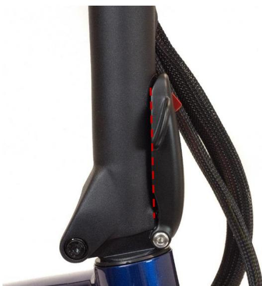
Fermez le loquet du guidon comme sur l'illustration. Le loquet doit commencer à présenter de la résistance quand il se trouve entre 25 mm et 35 mm d'écart de la position complètement fermée. Voir la section 5 pour l'entretien et le réglage.
