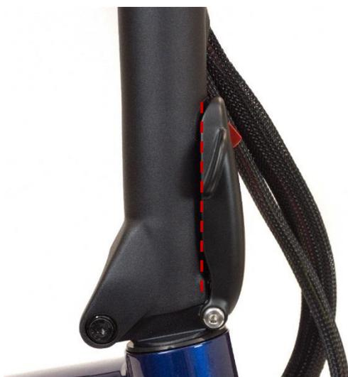
Fermez le loquet de la potence. Il doit commencer à présenter de la résistance à une distance de 25 à 35 mm de la potence. Si ça n'est pas le cas, répétez les étapes ci-dessus au besoin.
