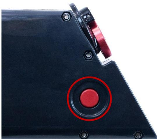
**PRENEZ DE BONNES HABITUDES !** Une fois que la batterie est chargée à fond et le chargeur débranché, mettez la batterie hors tension. Voir la section 10.5 Bouton marche/arrêt de batterie pour en savoir plus. En tout état de cause, il est déconseillé de laisser le Gocycle en charge pendant plus de 24 heures sans discontinuité.
