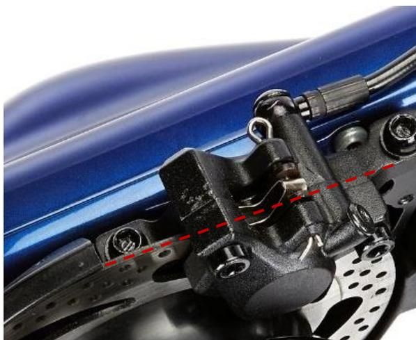
Veillez à ce que l'étrier de frein soit parallèle au rotor à disque une fois serré pour éviter tout frottement du disque.
