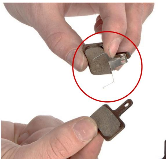
Remplacez les plaquettes de frein si nécessaire avant de les remonter.
