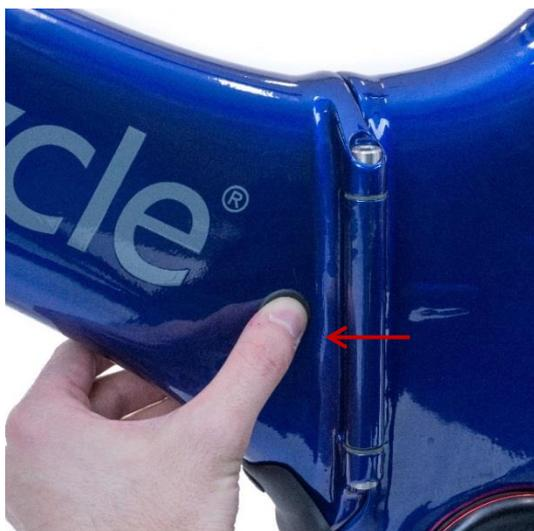
Appuyez sur le bouton une fois (moins d'1/2 seconde). Cela a pour effet de mettre la batterie sous tension
