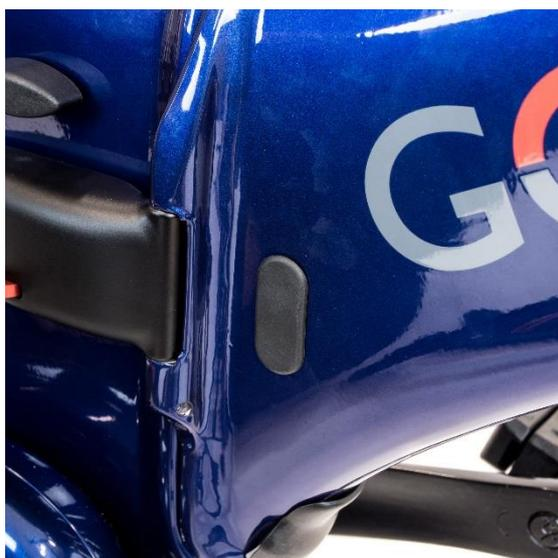
Débranchez le câble de charge et remettez en place le cache-port de charge en caoutchouc.
