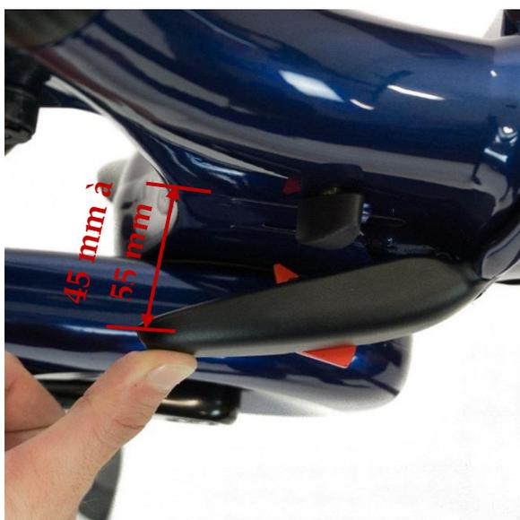
Fermez le loquet du cadre comme sur l'illustration. Le loquet doit commencer à présenter de la résistance quand il se trouve entre 45 mm et 55 mm d'écart de la position complètement fermée. Voir Réglage du loquet du cadre.
