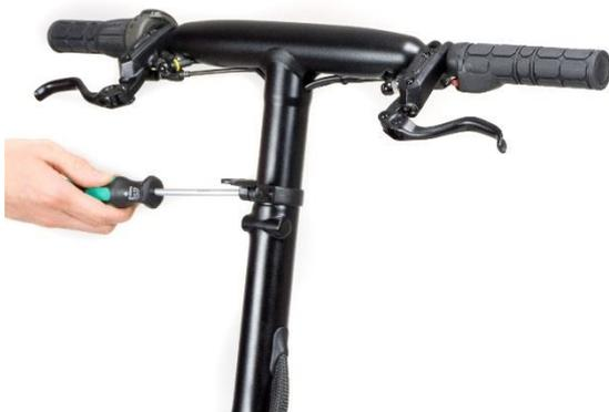
Posez le support autour de la partie supérieure de la potence et serrez-le, à l'aide d'un tournevis, pour le maintenir en place, comme sur l'illustration.
