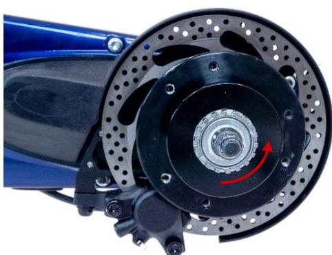
Déposez la roue PitstopWheel.
