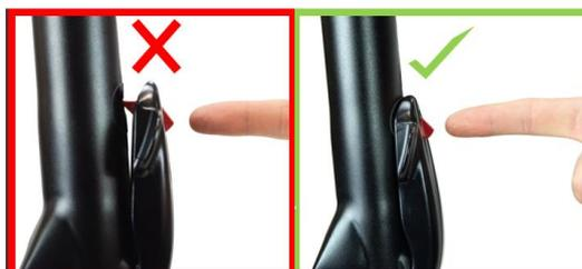
**AVERTISSEMENT** : Si le contrôle de sécurité des loquets de pliage échoue, c'est le signe d'un risque de blessure possible : dans ce cas, n'utilisez pas votre Gocycle.
