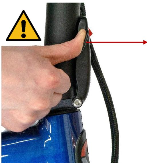
Poussez fortement dans le sens indiqué pour vérifier que le loquet est verrouillé. Vérifiez que les loquets sont verrouillés. Le loquet ne doit normalement pas s'ouvrir quand on appuie fort dessus dans le sens indiqué.
