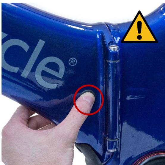
Désactivez la batterie en appuyant sur le bouton marche/arrêt et en le maintenant enfoncé. Maintenez la pression pendant ½ seconde ou plus avant de relâcher.
