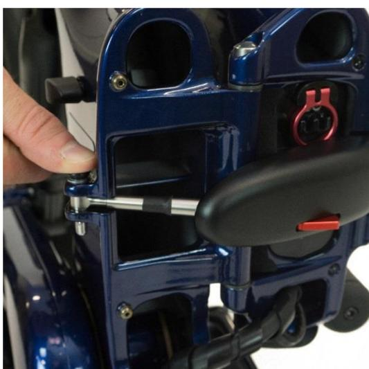
Si le loquet est trop serré, faites tourner d' ½ tour l'étau du loquet dans le sens des aiguilles d'une montre pour raccourcir l'étau.
