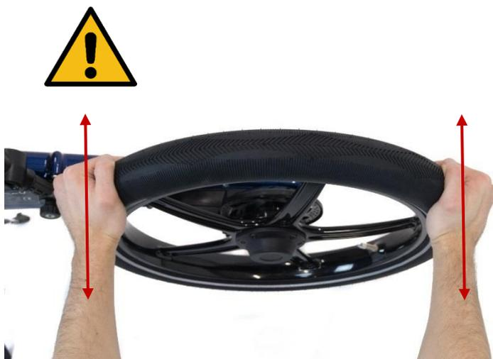
Pour vérifier si un réglage est nécessaire, bougez la roue arrière au niveau de la jante d'un côté à l'autre en appuyant légèrement dessus.
