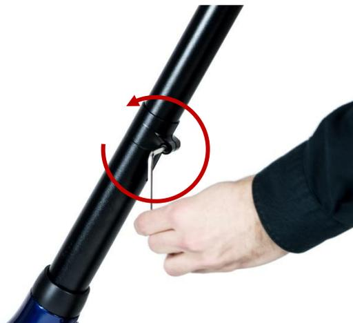
Desserrez le boulon de la tige de selle en utilisant la clé hexagonale, comme sur l'illustration.
