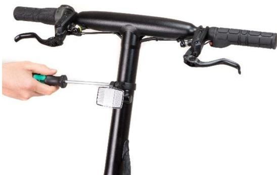
Réglez le support pour vous assurer que le catadioptr est à la verticale et serrez le boulon à un couple compris entre 4 Nm et 6 Nm.
