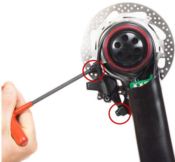
Repérez et retirez les deux boulons de fixation de l'étrier
