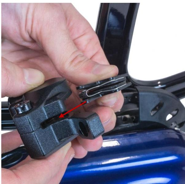
Remplacez les plaquettes de frein si nécessaire. Pincez-les avec le ressort et remontez-les dans l'étrier.
