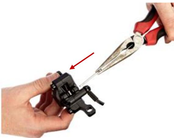
Remettez en place la goupille fendue pour fixer les plaquettes de frein en position.
