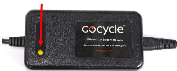
Le voyant du chargeur devient orange pour indiquer la mise en charge. Le temps de charge varie de 3,5 à 7 heures en fonction du modèle et du chargeur utilisés. Le chargeur illustré est le chargeur standard fourni avec votre Gocycle et prendra 7 heures pour recharger à fond une batterie à plat. Pour réduire le temps de charge à 3,5 heures, un chargeur rapide Gocycle est en vente (« Gocycle Fast Charger »). Visitez le site [www.gocycle.com](http://www.gocycle.com) pour plus d'informations.
