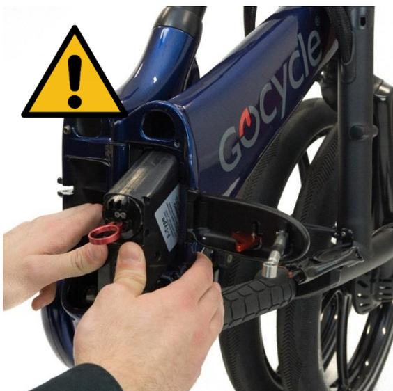
Tenendo la batteria spenta, inserire la batteria nel telaio come mostrato in figura.
