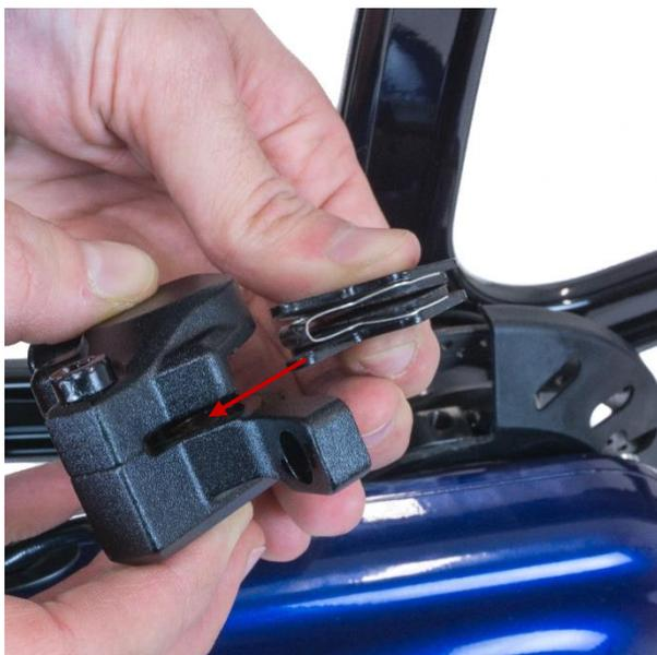
Sostituire le pastiglie dei freni a seconda delle necessità. Ancorare le pastiglie alla molla e reinstallarle all'interno della pinza freno.
