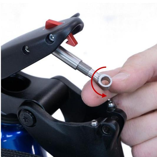
Se il fermo risulta eccessivamente allentato, ruotare il rinforzo in senso antiorario di mezzo giro per allungarlo.
