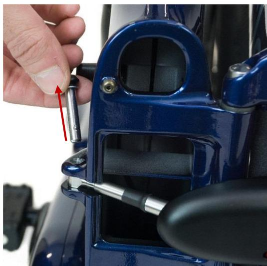
Identificare il perno di arresto del fermo a scatto del telaio come mostrato.
