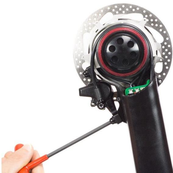
Reinstallare la pinza freno anteriore. Serrare i bulloni di fissaggio della pinza freno a una coppia di 6–8 Nm.
