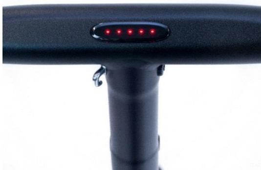
Quando la Gocycle è accesa, il mini-display si illumina mostrando l'autonomia residua della batteria. L'accensione di un solo LED corrisponde a un livello di carica pari a circa il 20% della batteria.
