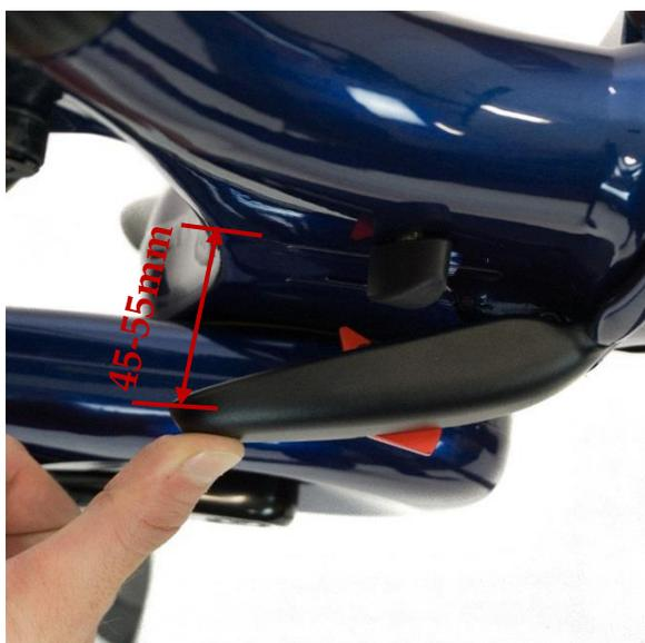
Chiudere il fermo a scatto del telaio come mostrato in figura. Il fermo a scatto dovrebbe iniziare a irrigidirsi a una distanza di 45-55 mm dalla posizione di chiusura. Vedere 5.12 Regolare il fermo a scatto del telaio
