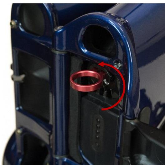
Ruotare l'anello della batteria a un angolo compreso tra 90° e 180° per consentire l'innesto della linguetta dietro il telaio.
