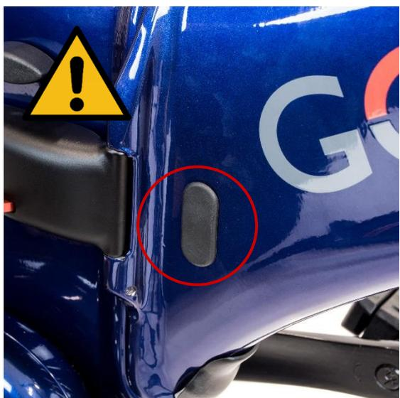
**⚠ ATTENZIONE:** Assicurarsi che il coperchio in gomma della porta di ricarica sia stato richiuso correttamente prima di utilizzare la bicicletta. In caso contrario, la batteria potrebbe danneggiarsi a seguito dell'ingresso di acqua, invalidando la garanzia.
