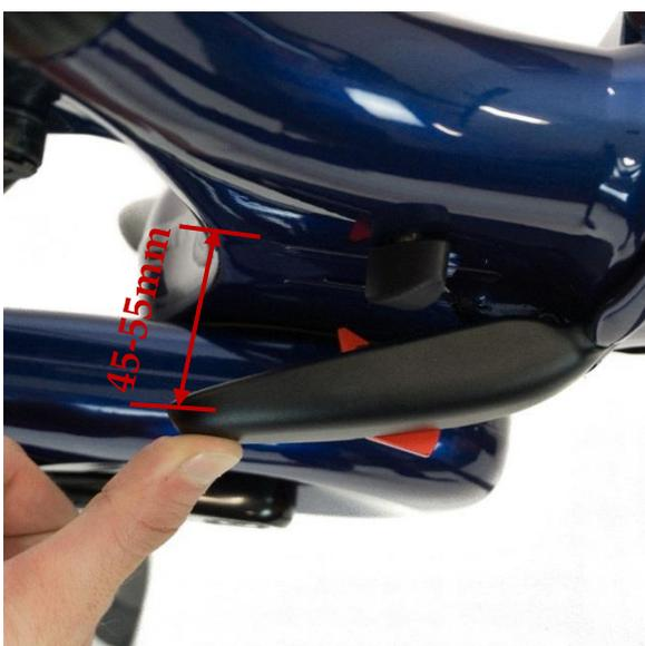
Chiudere il fermo a scatto del telaio come mostrato in figura. Il fermo a scatto dovrebbe iniziare a irrigidirsi a una distanza di 45-55 mm dalla posizione di chiusura. Vedere Regolare il fermo a scatto del telaio.
