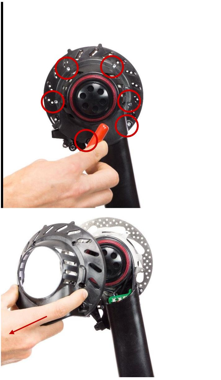
Identificare e rimuovere i sei bulloni di fissaggio del carter motore
