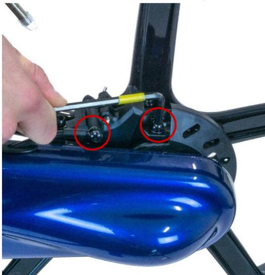
Identificare e rimuovere i due bulloni di fissaggio della pinza freno posteriore (figura).
