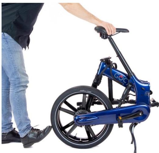
Dopo aver spostato la Gocycle, posizionare un piede dietro la ruota e ruotare la Gocycle in avanti in modo da appoggiarla sul cavalletto e sulle ruote.
