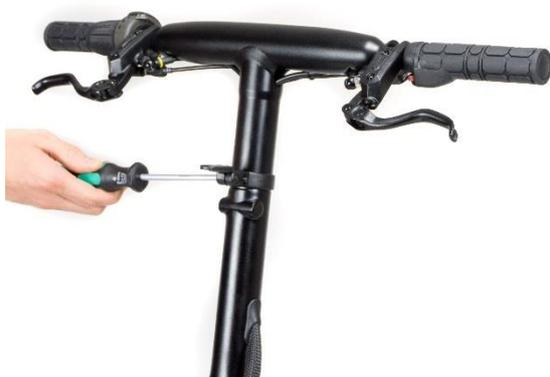
Posizionare la staffa del catadiottro posteriore attorno all'estremità superiore dello stelo, quindi serrare con l'ausilio di un cacciavite per fissare nella posizione mostrata in figura.
