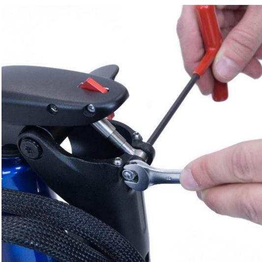
Utilizzando una chiave a brugola da 4 mm e una chiave inglese da 8 mm, allentare il dado e il perno di bloccaggio.
