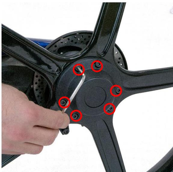
Allentare i sei bulloni di fissaggio della ruota posteriore.
