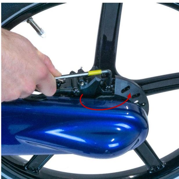
Reinstallare entrambi i bulloni di fissaggio della pinza freno. Serrare a una coppia di 6-8 Nm.
