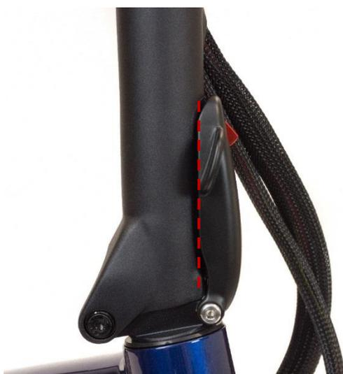
Chiudere il fermo a scatto dello stelo manubrio. Il fermo a scatto dovrebbe iniziare a irrigidirsi a una distanza di 25-35 mm dalla posizione di chiusura. Se ciò non avviene, ripetere le operazioni precedente a seconda delle necessità.
