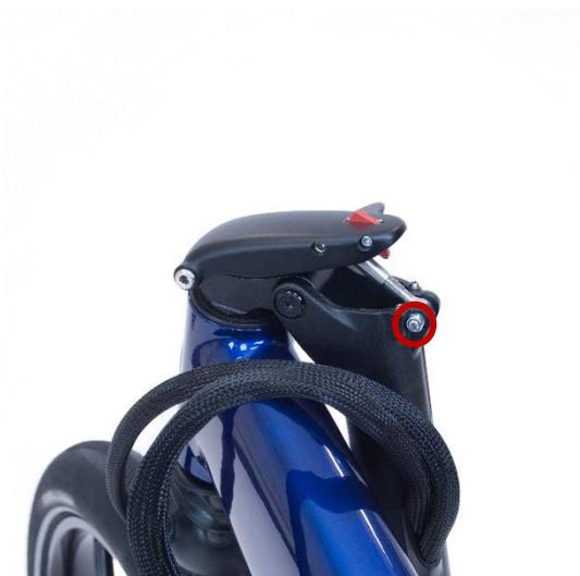
Identificare il dado e il perno di bloccaggio del fermo.
