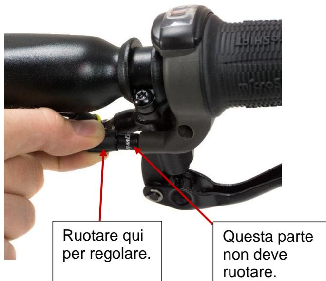
Ruotare il fermaguaina del regolatore cambio in senso orario o antiorario per regolare il cavo del cambio. Ruotare in senso orario (allentando il cavo) se il selettore marcia innesta una marcia superiore rispetto a quella desiderata; ruotare invece in senso antiorario (serrando il cavo) se il selettore innesta una marcia inferiore rispetto a quella selezionata.
