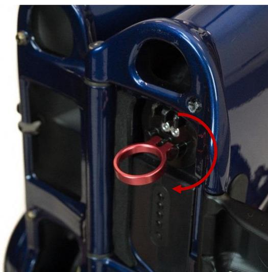
Ruotare l'anello di 180° orientandolo verso il basso. Questo permetterà di rilasciare la batteria dal telaio.
