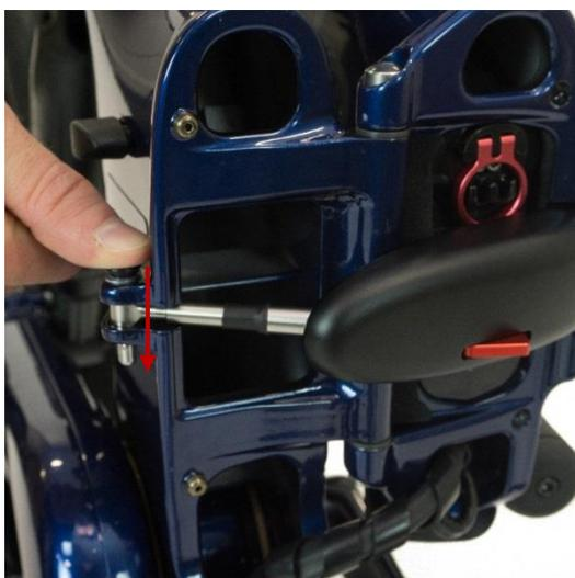
Assemblare nuovamente il fermo a scatto del telaio come mostrato in figura, verificando che il perno di arresto sia correttamente bloccato nella posizione mostrata.
