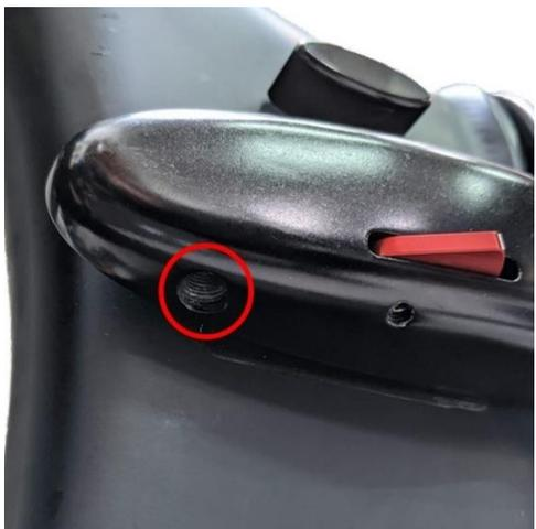
„Fold Latch Pivot Pin“ am Rahmen fehlt.
