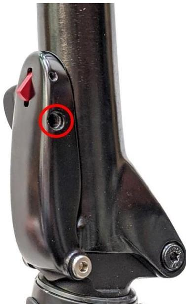
„Fold Latch Pivot Pin“ an Lenkerstange fehlt.
