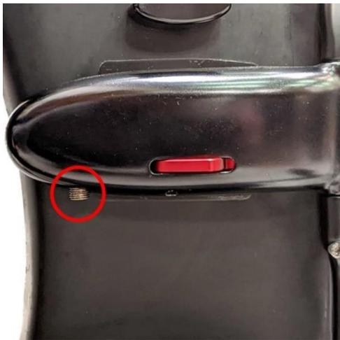
„Fold Latch Pivot Pin“ am Rahmen ist lose.
