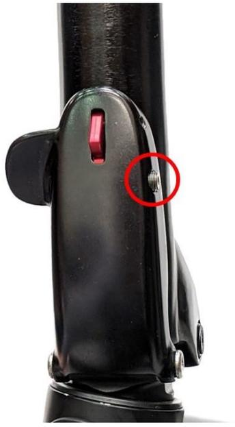
„Fold Latch Pivot Pin“ an Lenkerstange ist lose.
